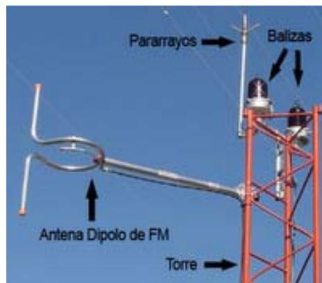
Figura. 3.6. Sistema Radiante
