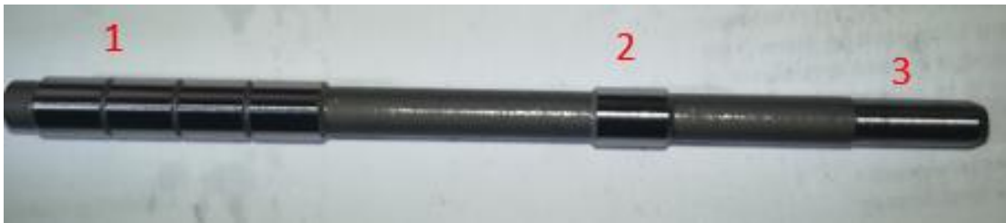
Figura 55. Sectores inspeccionados en el émbolo de mando
