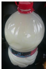
Figura 18. Emulsión de diésel y agua en porcentaje de 20%
