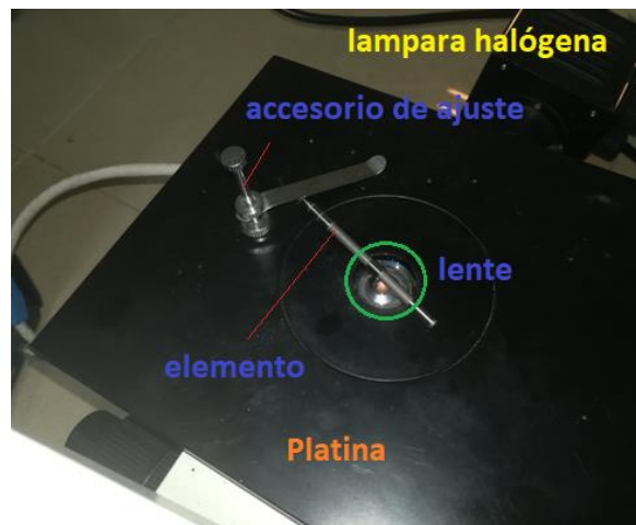
Figura 53. Colocación del elemento
