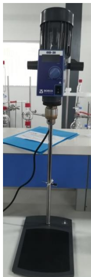
Figura 45. Agitador mecánico OSD-20 BOECO
