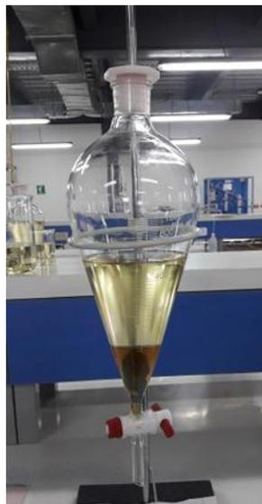
**Figura 28.** Separación fases metil éster y glicerol
