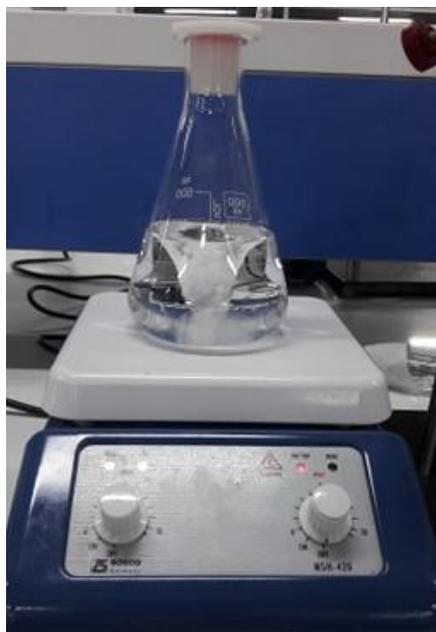
**Figura 26.** Preparación de metóxido de potasio
