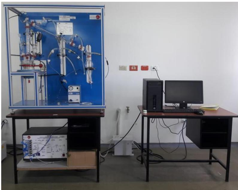
**Figura 21.** Columna de Craqueo controlada por computador
