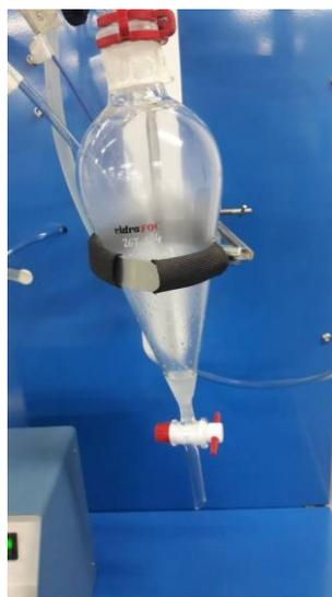
**Figura 36.** Destilado de la reacción de craqueo
