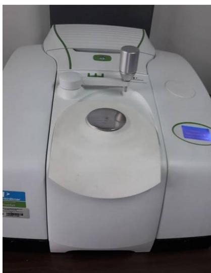
**Figura 23.** Espectrofotómetro infrarrojo con Transformada de Fourier con accesorio de muestreo universal ATR
