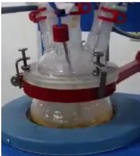
**Figura 35.** Reactor de la columna de craqueo
