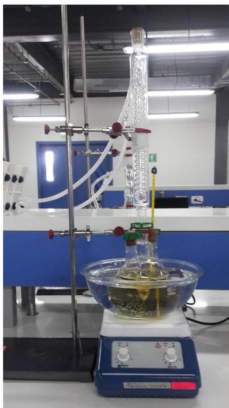
**Figura 20.** Equipo para la reacción de Transesterificación
