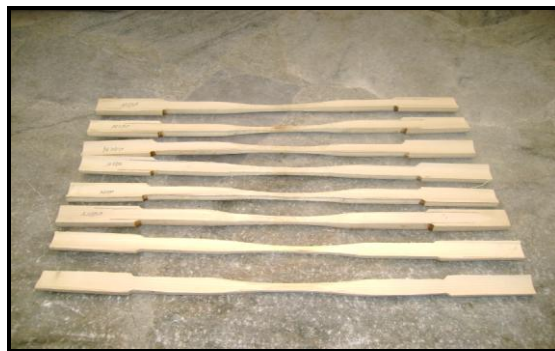
Figura 3.2 Probetas para tracción ahusadas
