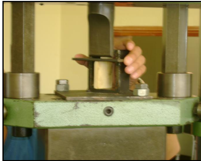
Figura 3.7 Ensayo de corte paralelo a la fibra. Escuela Politécnica del Ejército Laboratorio de Resistencia de Materiales
