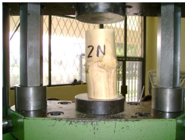
Figura 3.5 Máquina de compresión universal y probeta de guadua, Escuela Politécnica del Ejército, Laboratorio de Resistencia de Materiales
