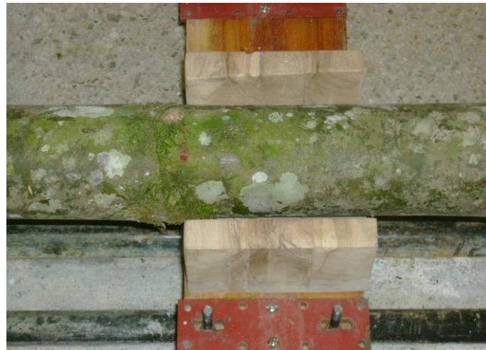
Figura 3.11 Apoyos en los extremos de madera
