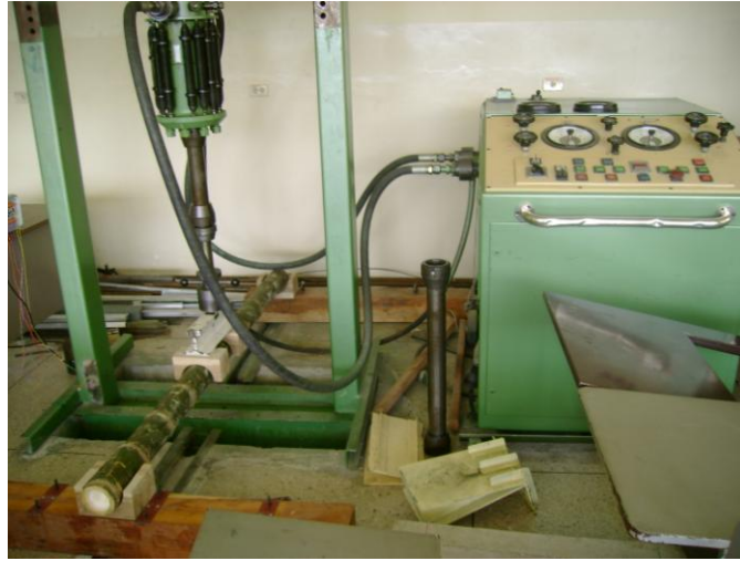
Figura 3.10 Maquina de Carga para el ensayo de flexión, Escuela Politécnica del Ejército, Laboratorio de Resistencia de Materiales
