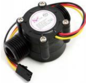
Figura 37. Sensor de flujo YF-S201 Fuente: (Muñoz & Pérez, 2016)
