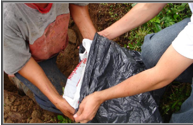
Figura 5.5 : Toma de muestra inalterada
