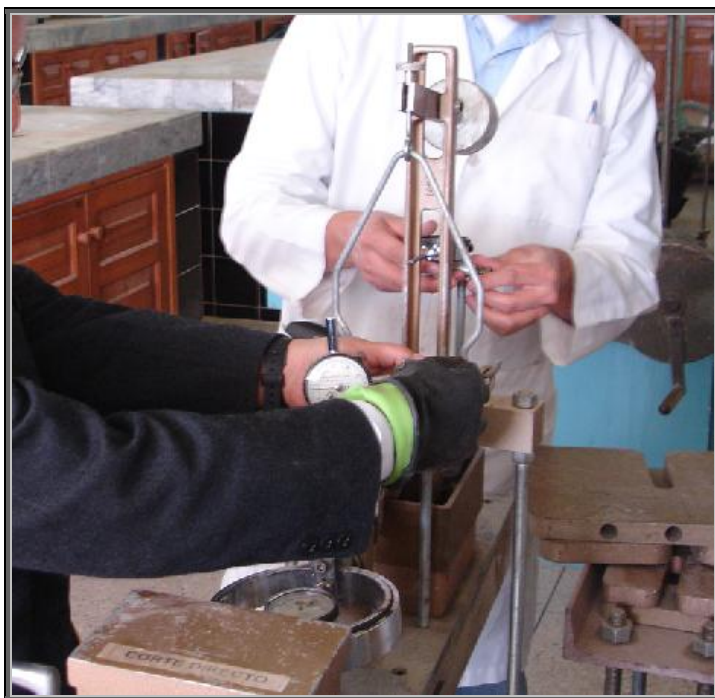
Figura 5.9: Realización del ensayo de Corte Directo
