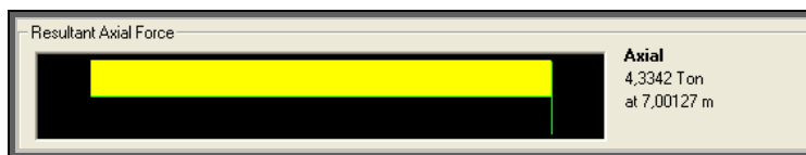
Figura 6.17: Tensión sobre el cable carril
