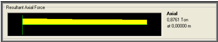
Figura 6.20.- Carga axial sobre el cable motriz.
