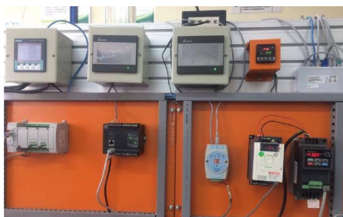
Figura 33. Módulo didáctico con protocolo abierto Modbus FUENTE: (López Salazar & Mora Ledesma, 2017)
