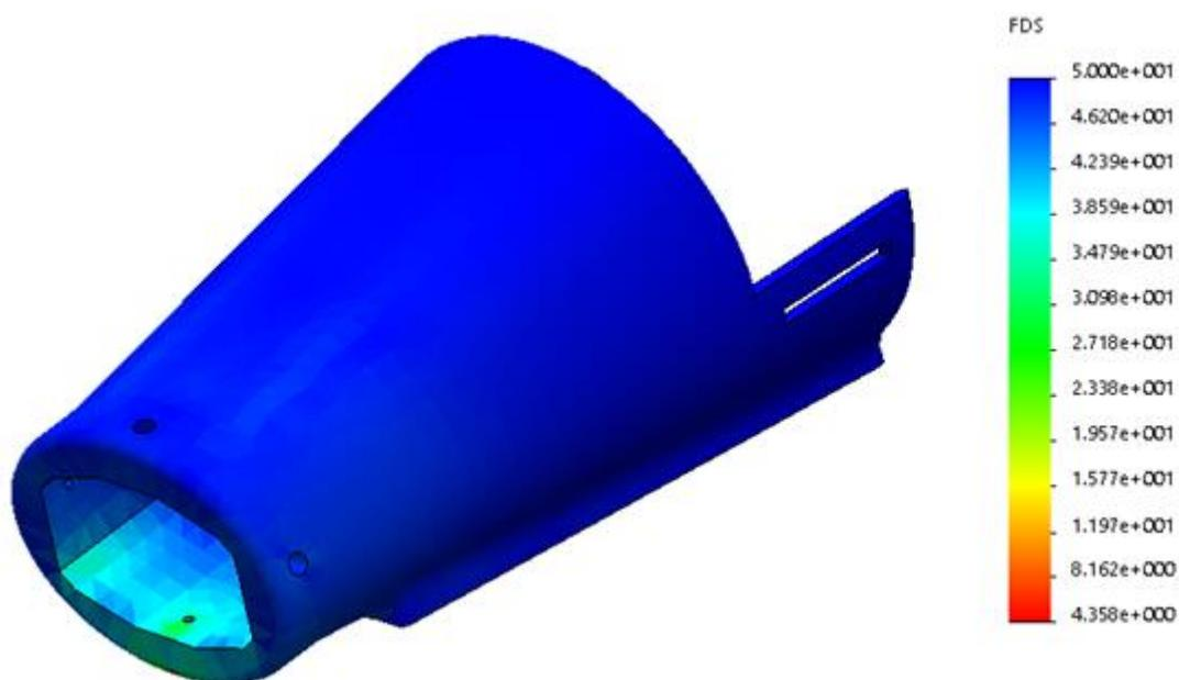
**Figura 34** Factor de seguridad de diseño en cada punto de la estructura
