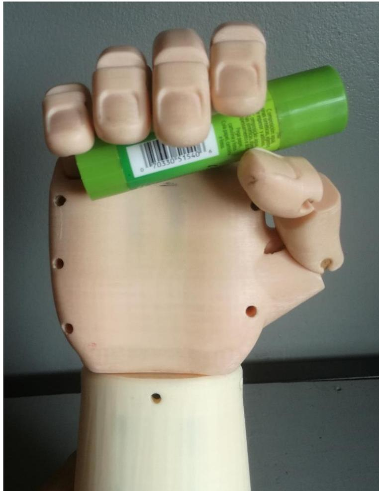
**Figura 65** Agarre cilíndrico
