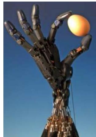
**Figura 17** Prótesis neumática Shadow
