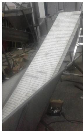
**Figura 82.** Banda transportadora
