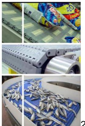
**Figura 12.** Banda transportadora modular
