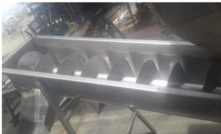
**Figura 80.** Transportador helicoidal
