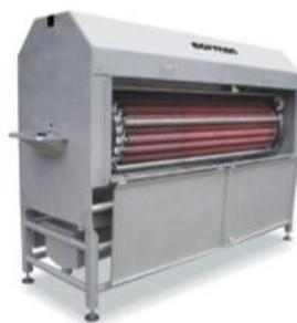
**Figura 5.** Peladora de revólver
