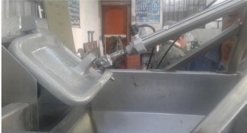
**Figura 86.** Colocación del pistón de apertura y cierre de la puerta de la peladora
