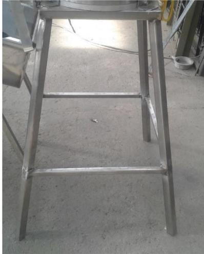
**Figura 84.** Estructura soporte peladora
