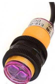
Figura 28. Sensor de proximidad fotoeléctrico infrarrojo E18-D80NK
