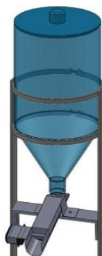
Figura 1. Tolva cilíndrica de acrílico Fuente: (Mata & Molina, 2014)
