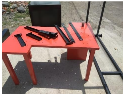
Figura 61. Piezas pintadas con pintura electroestática
