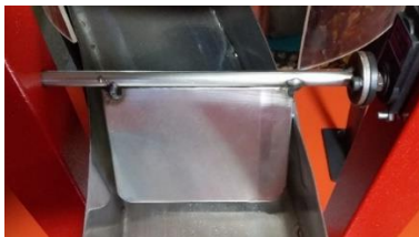
Figura 69. Compuerta de la tolva
