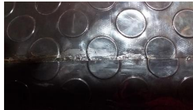
Figura 72. Traslape de la banda transportadora
