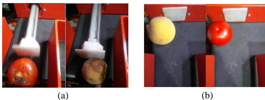
Figura 124. (a) Accionamiento actuador lineal, (b) Accionamiento banda transportadora
