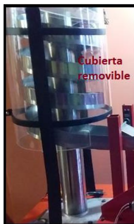
Figura 111. Sistema de alimentación con cubierta removible
