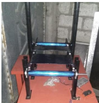
Figura 62. Ensamble de los soportes de la banda transportadora
