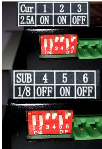
Figura 76. Configuración de los switch del driver
