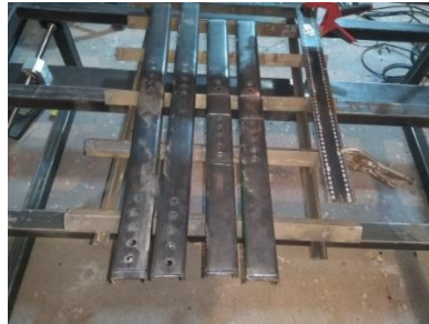
Figura 60. Perfiles tipo C de la banda transportadora
