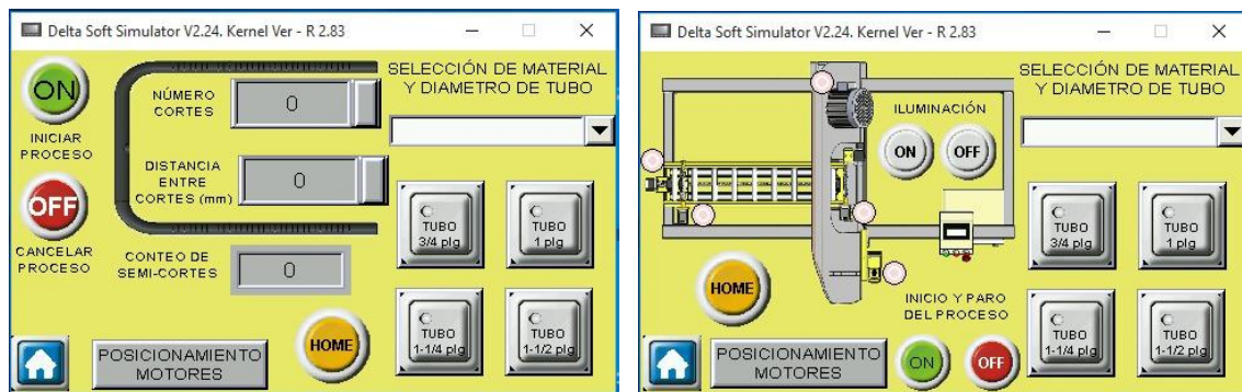
Figura 104. Pantallas de control manual y automático
