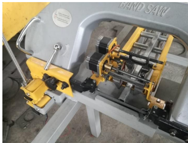
Figura 94. Acoplamiento del gripper estático en la mesa base
