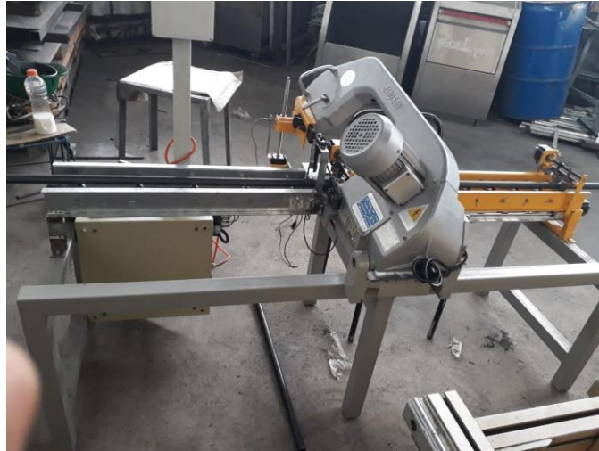
Figura 86. Montaje de la mesa de salida del tubo en la estructura.
