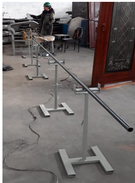
Figura 89. Montaje de rodillos al sistema de alimentación.
