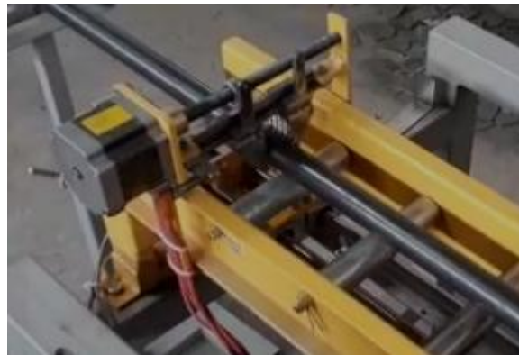
Figura 93. Acoplamiento del gripper móvil en la mesa de translación del tubo
