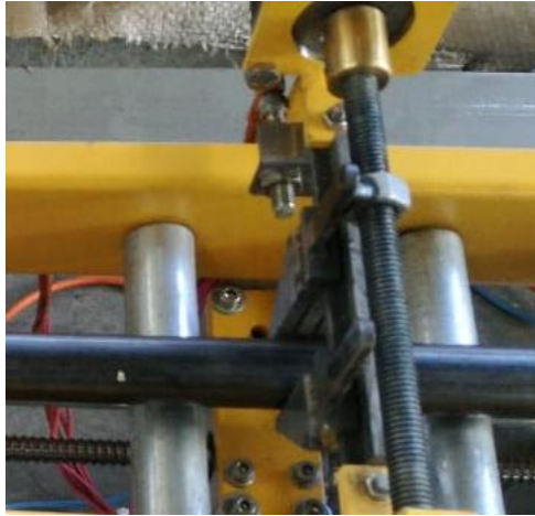
Figura 108. Sensor de posicionamiento gripper móvil
