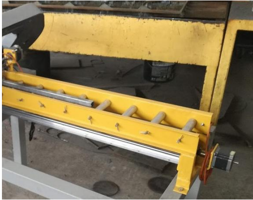
Figura 98. Motor para la traslación del material
