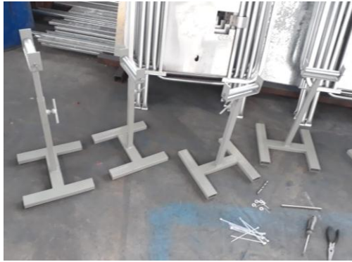
Figura 88. Construcción de caballetes y acoplamiento de rodillos.
