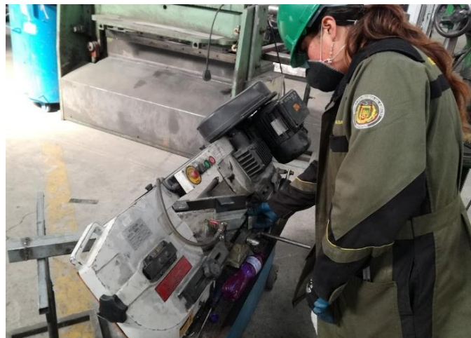
Figura 87. Corte de tubo estructural para construcción de rodillos.
