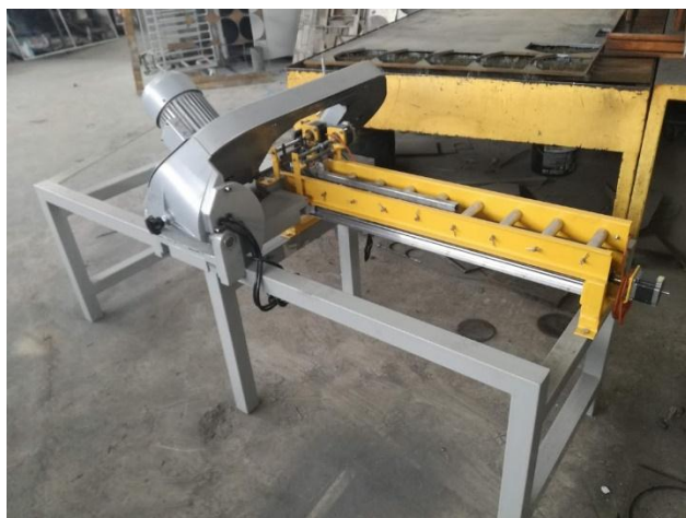
Figura 85. Montaje de la mesa de traslación del tubo en la estructura base
