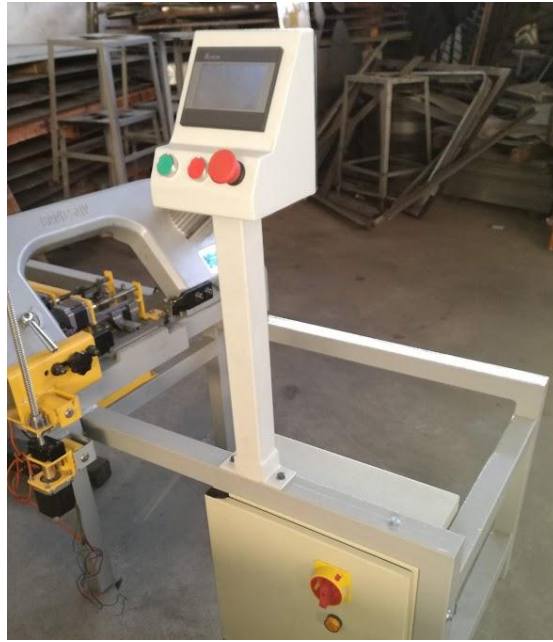
Figura 81. Montaje del panel de mando en la estructura de la mesa
