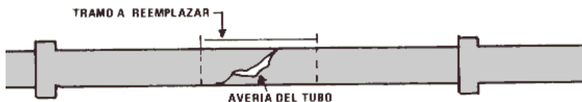
Figura 21 Fisura en tubería de acueducto Fuente: (SENA, 2018)
