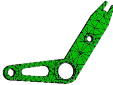
Figura 26 Modelo en Software CAD, Discretizado en Software CAE
