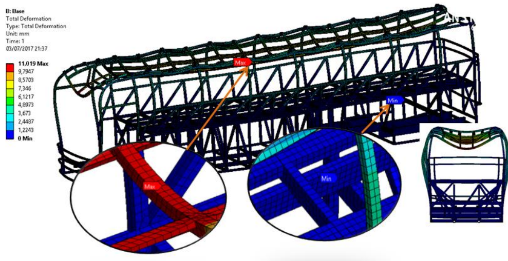
Figura 158 Deformación máxima efectuada en el techo de la carrocería autoportante
