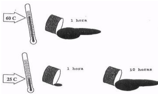
Figura 2.1 (Dependencia tiempo-temperatura del cemento asfáltico)
