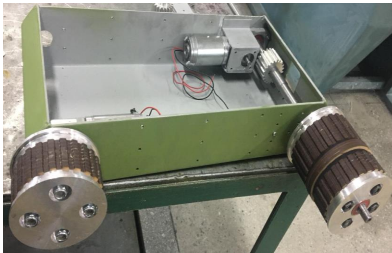
Figura 80. Ensamblaje del eje y colocación de motores
