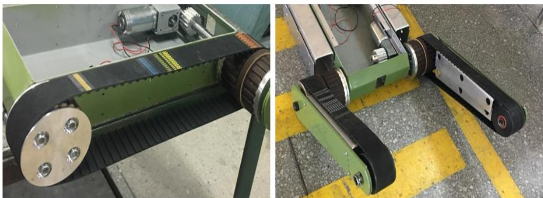
Figura 82. Proceso de ensamblaje de ruedas, bandas y engranaje
