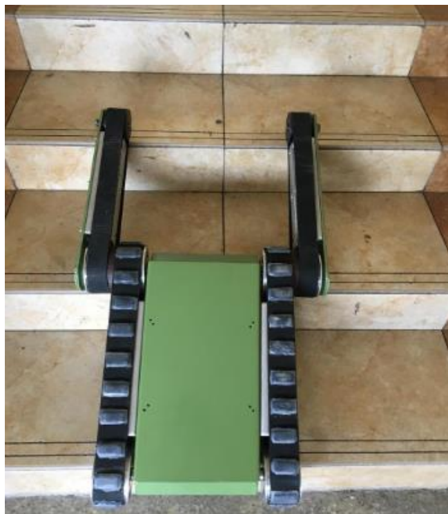
Figura 89. Desplazamiento del robot en gradas
