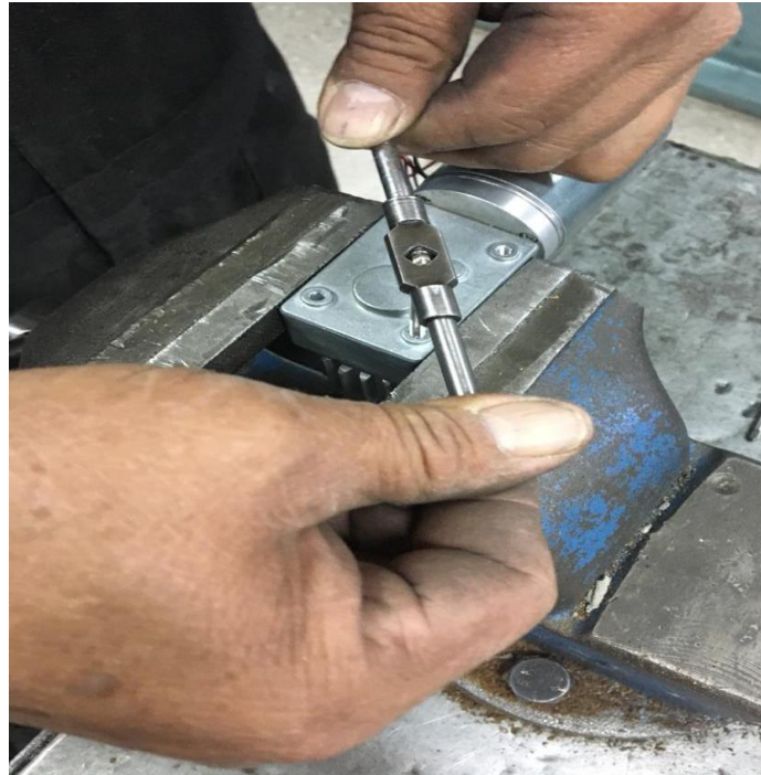
Figura 79. Proceso de roscado interno
