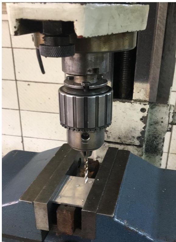
Figura 70. Proceso de taladrado de acoples
