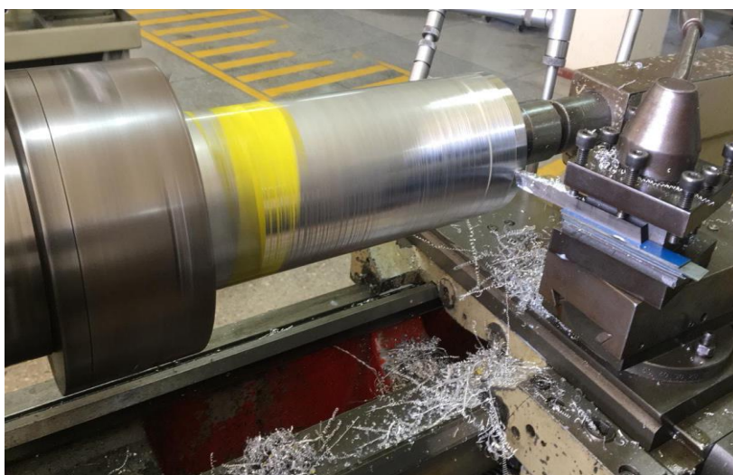
Figura 77. Proceso de torneado de cilindros para engranajes
