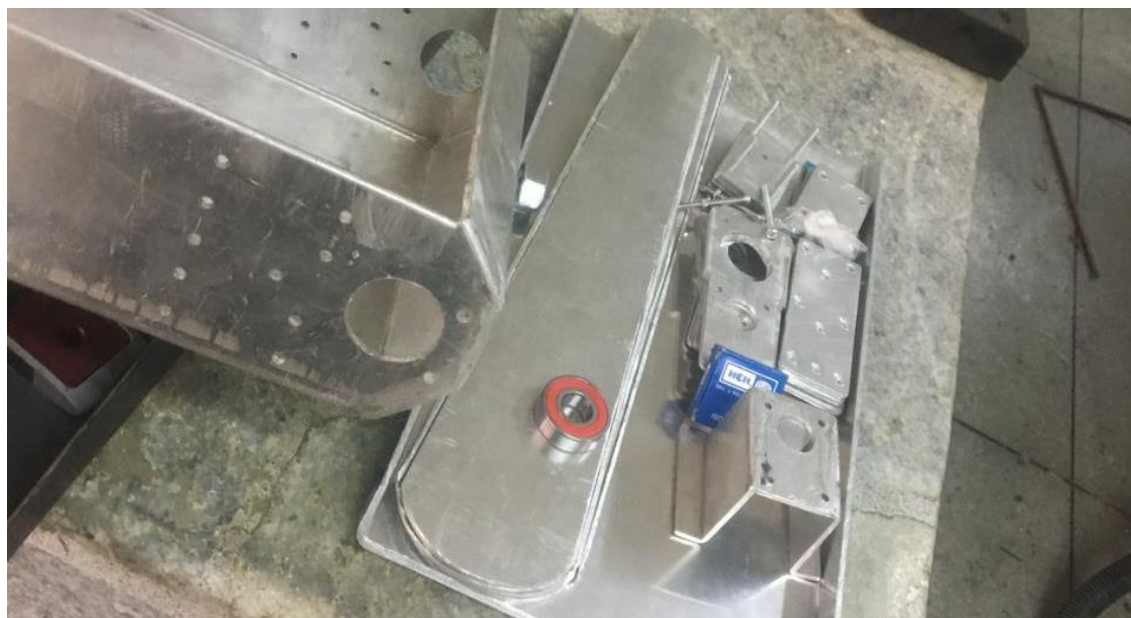
Figura 71. Componentes fabricados en lámina de aluminio de 3 mm
