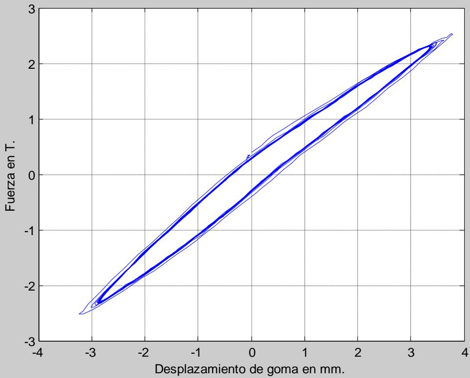
Figura 4.45 Deformación 130%, 0.20 Hz.
