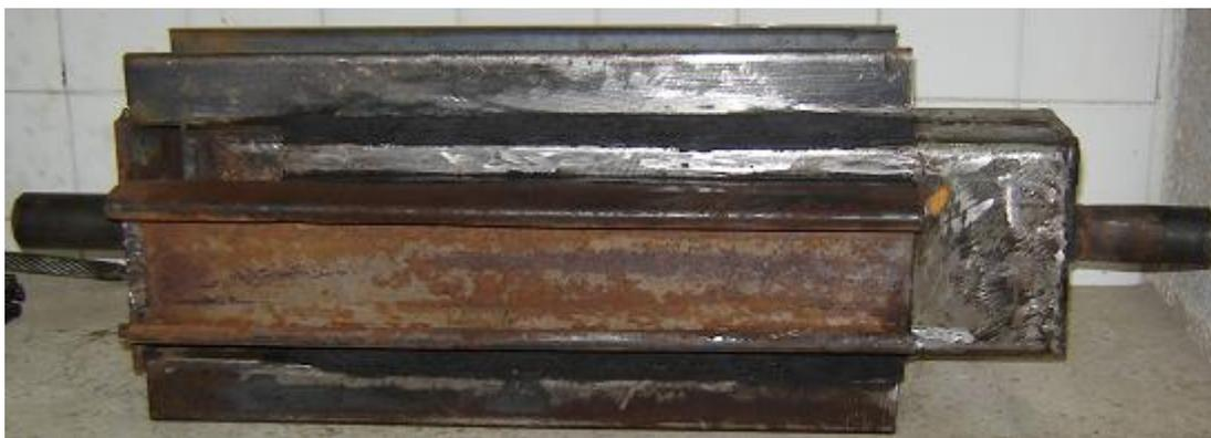
Figura 1.13. Amortiguador VE estudiado en Ecuador.
