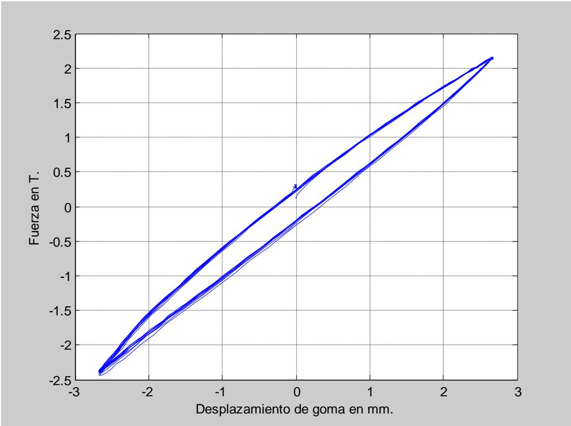
Figura 4.21 Deformación 90%, 0.10 Hz.
