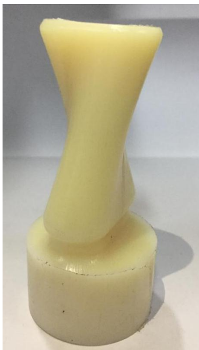
Figura 50. Resultado del maquinado de la pieza dibujada con mejor acabado Fuente:Propia
