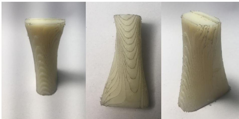
Figura 49. Resultado del maquinado de la pieza dibujada Fuente:Propia
