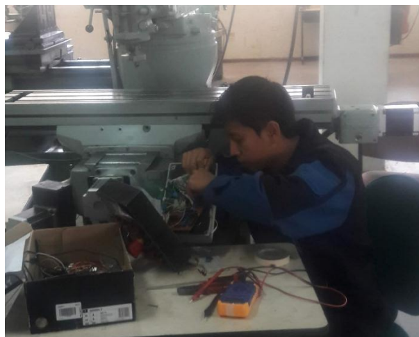
Figura 27. Conexión de la placa electrónica de la seguridad redundante Fuente: Propia
