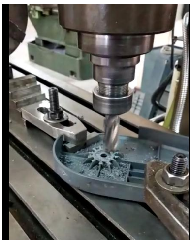
Figura 95. Fresado de los soportes de plástico, para adaptar acoples.
