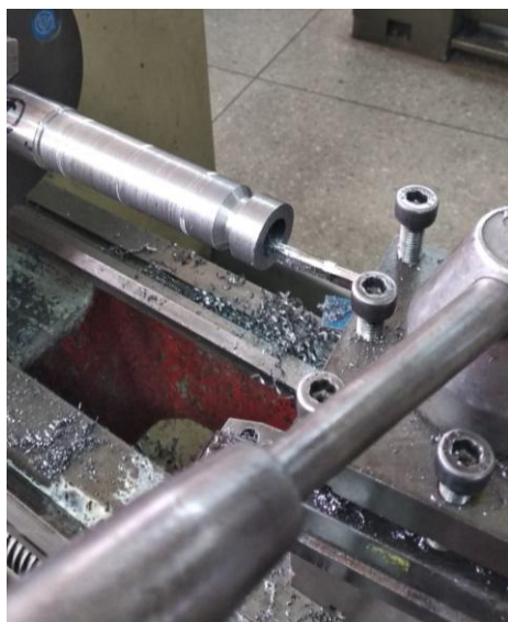
Figura 87. Desbaste interno, cuchilla de interiores.
