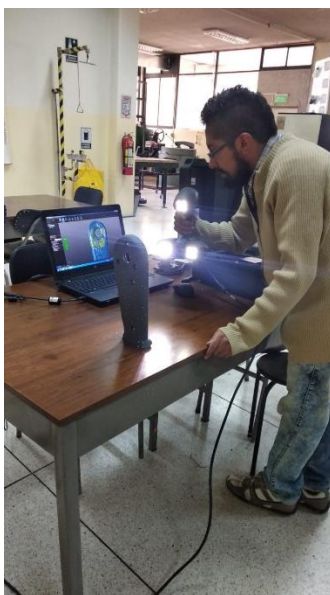
Figura 47. Escaneo 3D de acople perteneciente a la banda
