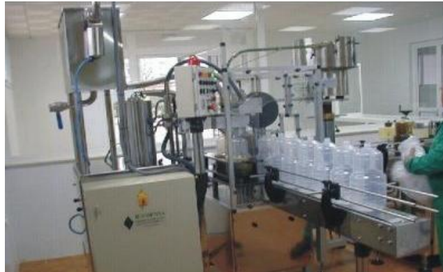
Figura 10. Automatización fija (Fuente: www.exsol.com.ar )
