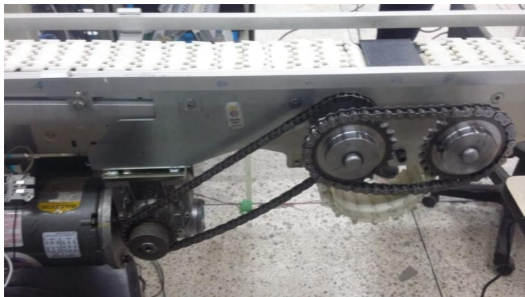
Figura 97. Implementación del mecanismo para lograr el movimiento bidireccional de la banda transportadora.
