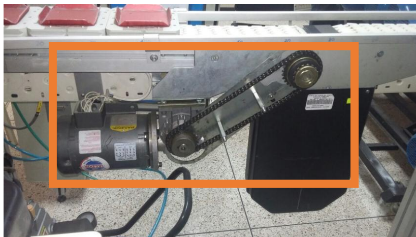
Figura 2. Motor y reductor unidireccional de la banda.
