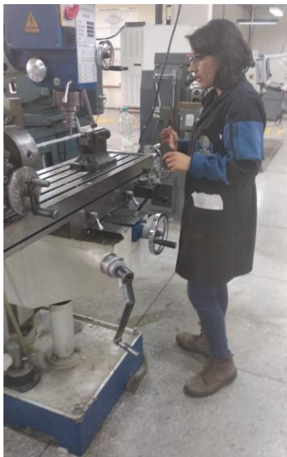
Figura 89. Fresado para la adaptación de chaveteros.
