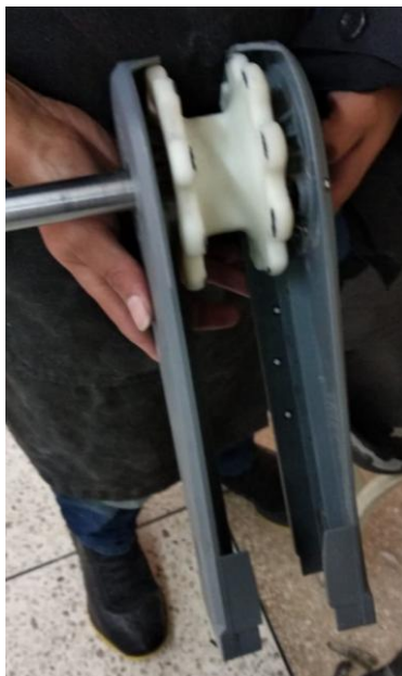
Figura 94. Adaptación del engrane de plástico, eje y soporte para la banda transportadora.
