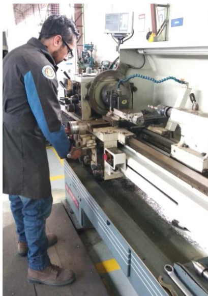
Figura 90. Refrentado y cilindrado de ejes.
