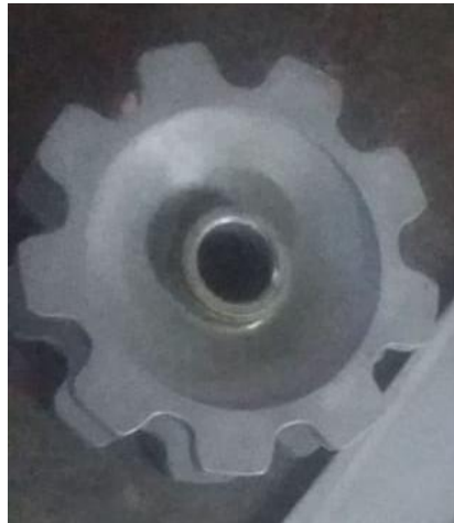
Figura 45. Engrane de transmisión de potencia originario de la banda.
