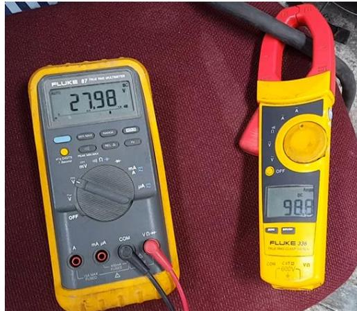
**Figura 8.** Adquisidor de datos (multímetro y amperímetro)
