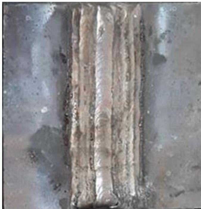
*Figura 13.* Cupón N° 4 (Temperatura de precalentamiento: 200 °C)
