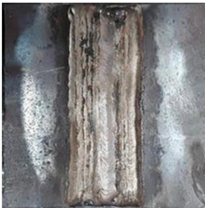
**Figura 11.** Cupón N° 2 (Temperatura precalentamiento: 100 °C)
