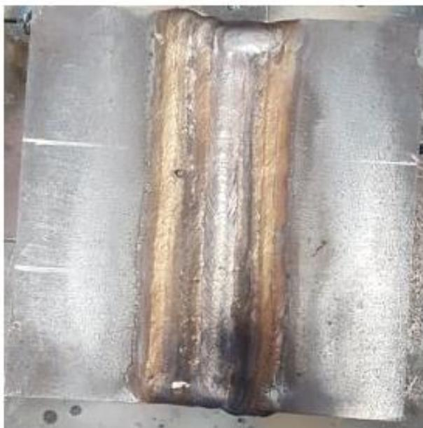
**Figura 14.** Cupón N°5 (Temperatura de precalentamiento: 300 °C)
