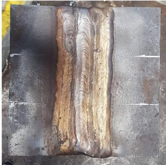
*Figura 12.* Cupón N° 3 (Temperatura precalentamiento: 150 °C)
