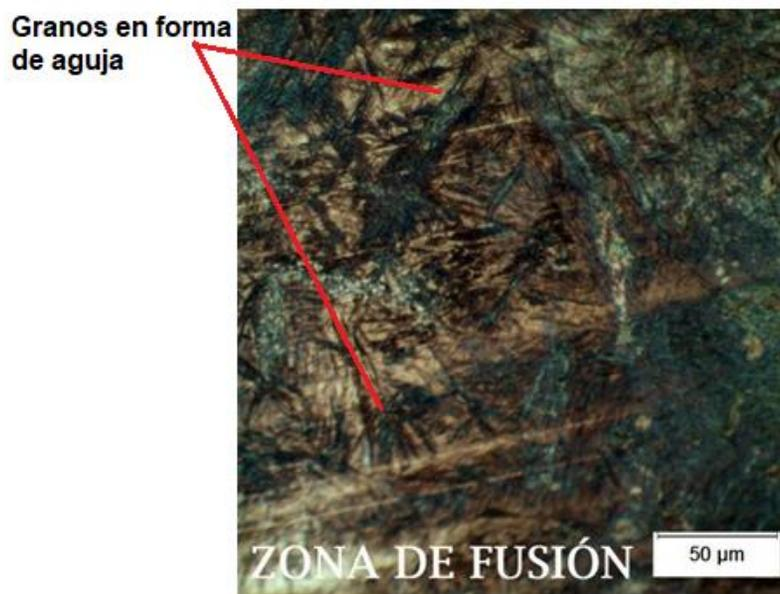
*Figura 35.* Micrografía de la zona de fusión de la probeta 2D (500X)
