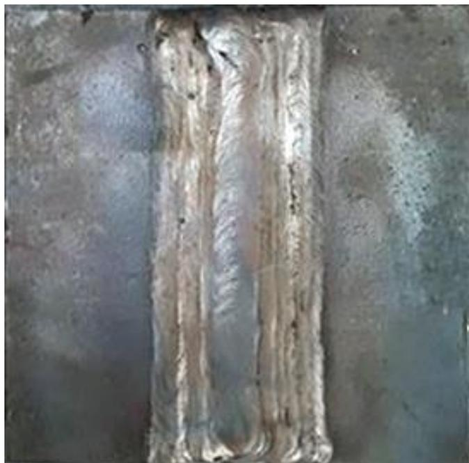
**Figura 10.** Cupón N° 1 (Temperatura precalentamiento: Temperatura ambiente 28 °C)
