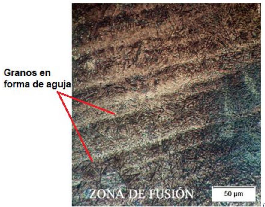
*Figura 39.* Micrografía de la zona de fusión de la probeta 4D (500X)
