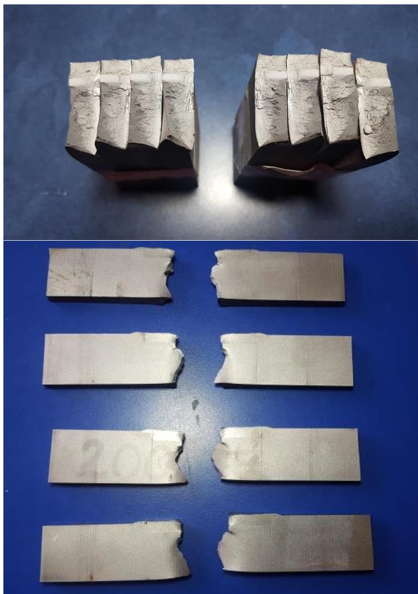
**Figura 50.** Probetas dobladas del cupón N° 4 (Temperatura de precalentamiento de 200°C)
