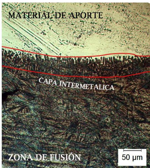
*Figura 38.* Micrografía de la interfase entre el metal de aporte y la zona de fusión de la probeta 4D (200X)
