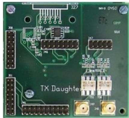
Figura 16. Tarjeta secundaria del USRP Fuente: (Pinar, 2015)
