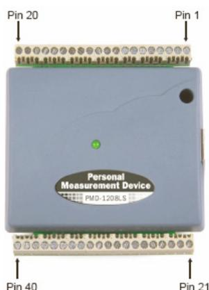
Figura. 3.6. Números de Pin de los terminales de la PMD-1208LS
