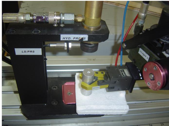
Figura. 5.63. Colocar la clavija en el agujero de la base
