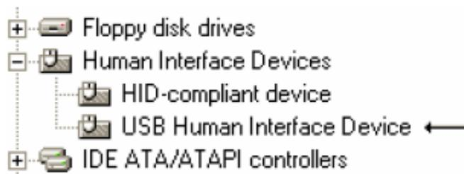
Hay un **USB Human Interface Device** en la lista por cada dispositivo PMD-1208LS conectado al sistema.
