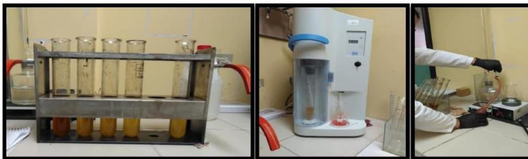
*Figura 13.* Análisis de proteína - Método Kjeldalh
