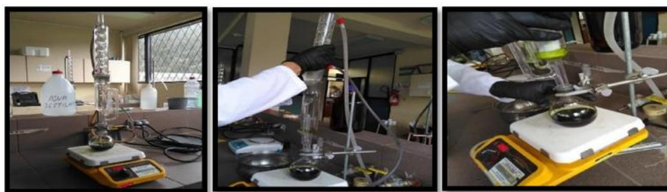
*Figura 14.* Análisis de grasa - Método Soxhlet
