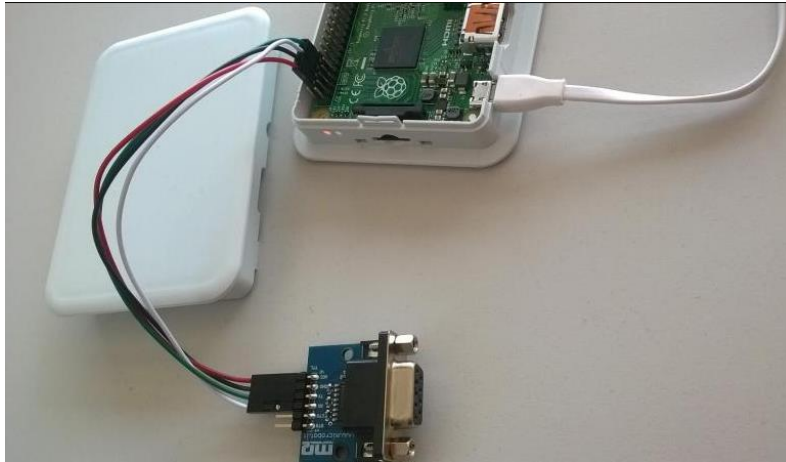
Figura 26 Conexión del Raspberry Pi con el adaptador RS-232
