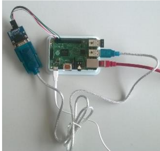
Figura 34 Conexión del puerto Serial de la Raspberry Pi
