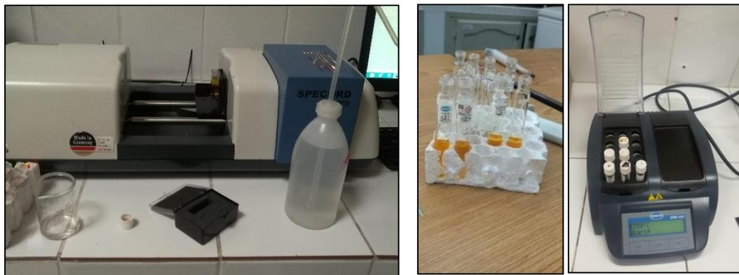
**Figura 28.** Lector de espectro, enfriador con viales de 16mm y Reactor térmico
