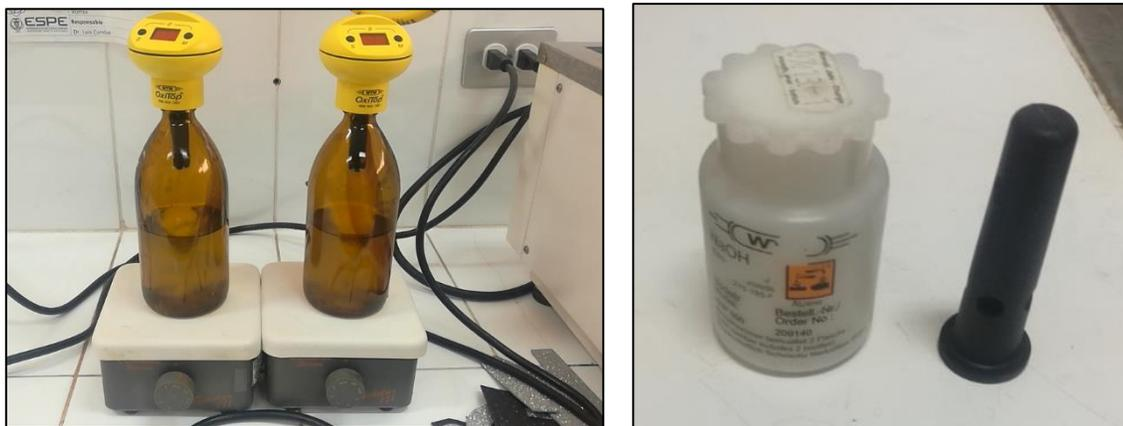
**Figura 27.** Botella y mesa agitadora, caucho y pastillas de hidróxido de sodio
