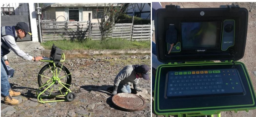
**Figura 41.** Cámara de inspección Verisigth Pro.
