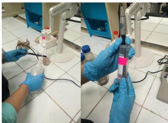
**Figura 25.** Calibración del medidor de pH con buffer
