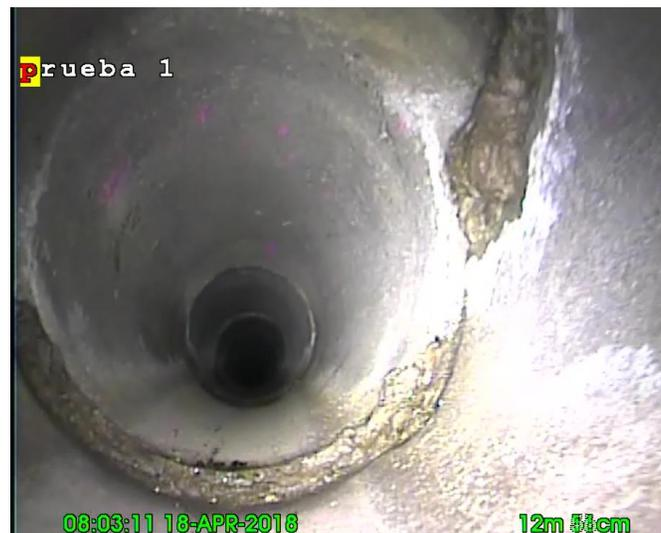
*Figura 43.* Mal diseño de juntas entre tuberías.
