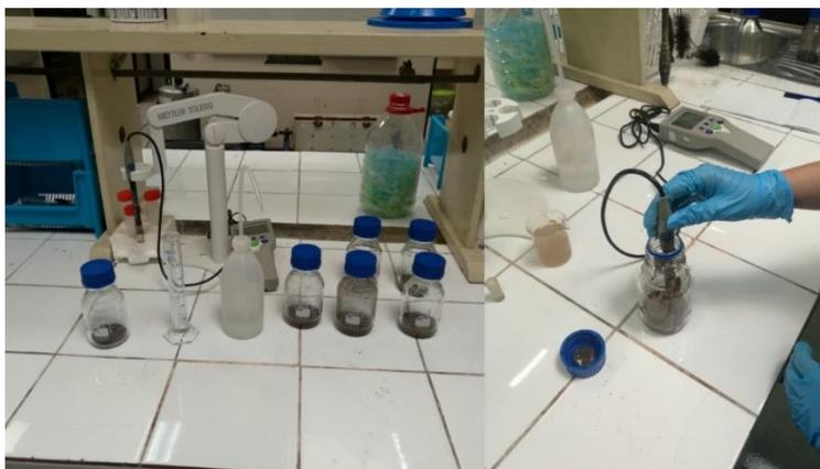
**Figura 26.** Medición de pH en las muestras de suelo
