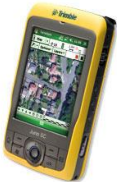
Figura 3.9. GPS Trimble Juno SC
