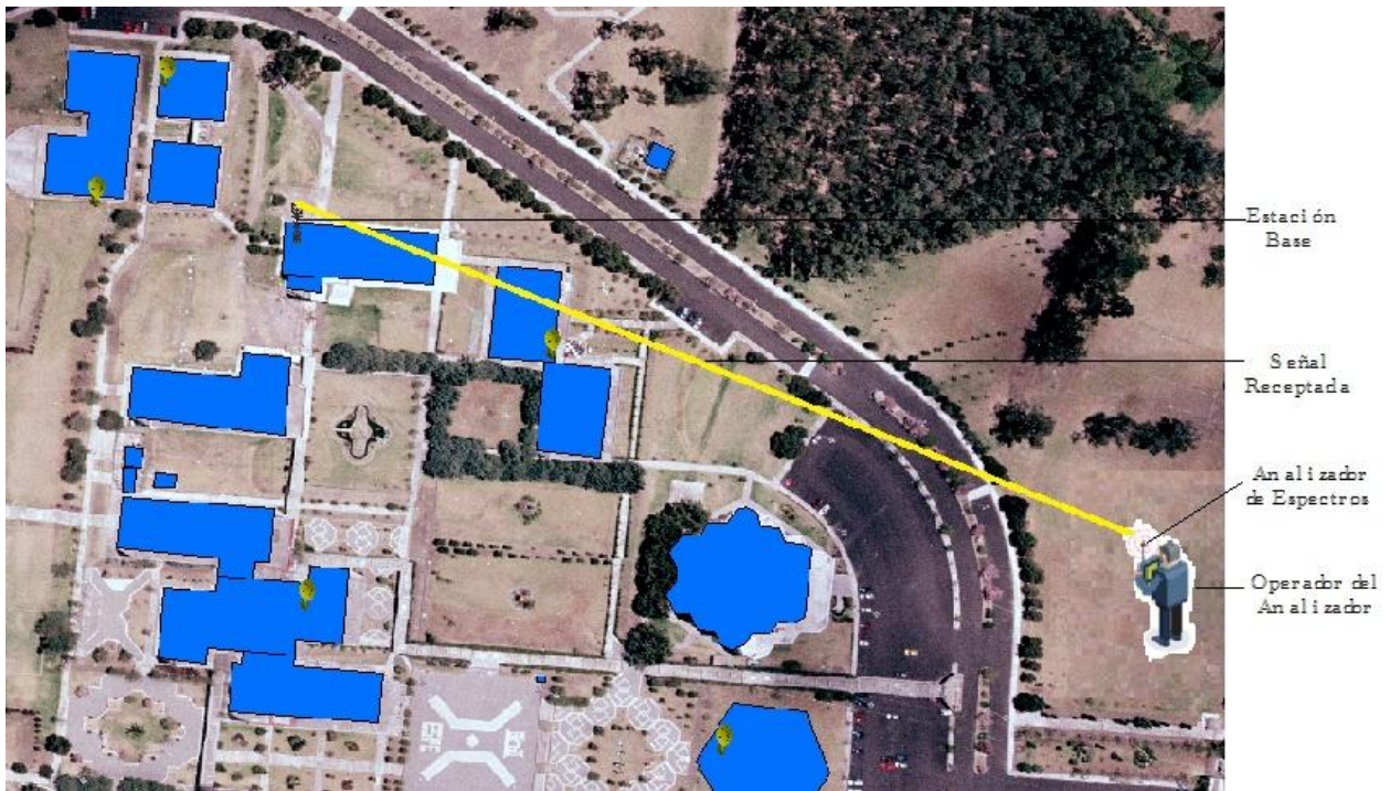
Figura 3.15. Manera como se debe tomar la medida de la señal WiMAX en el Campus Politécnico
