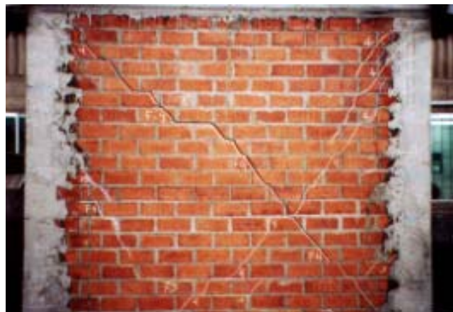
Figura 5.2 Falla de corte del muro de ladrillo ante carga lateral cíclica 39
