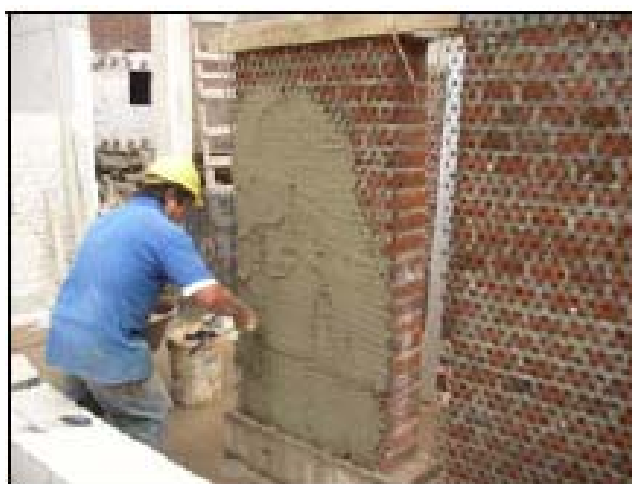
Figura 5.16 Muros reforzados con malla de polímero a ser ensayados a cargas cíclicas de corte en el plano. 51
