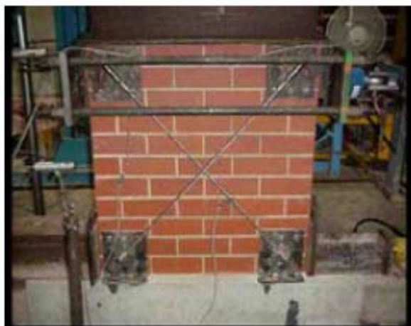
Figura 5.19 Reforzamiento de mampostería con cables 55
