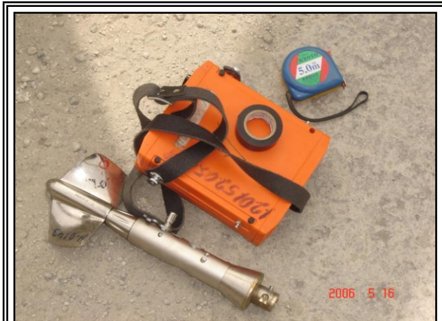
FOT. 44 EQUIPO PARA REALIZAR EL AFORO, HÉLICE 2-33888
