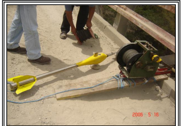
FOT. 43 MOLINETE : A. OTT KEMPTEN UTILIZADO EN EL AFORO REALIZADO.
