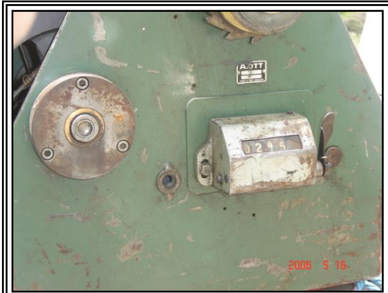
FOT. 42 MEDIDOR DE PROFUNDIDAD UTILIZADO EN EL AFORO REALIZADO.
