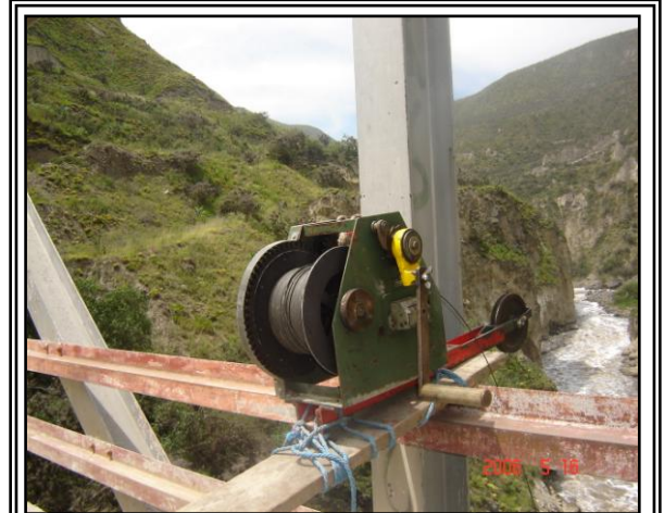
FOT. 45 POLEA CON CONTADOR DE VUELTAS PARA EL DESCENSO DEL EQUIPO
