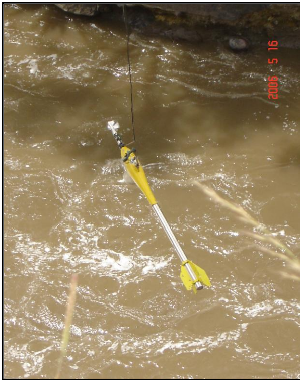
FOT. 46 MOLINETE DESCENDIENDO AL RÍO GUAYLLABAMBA SITIO DEL AFORO
