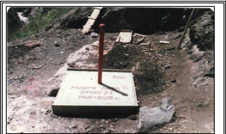
FOT. 24 SONDEO REALIZADO EN EL SITIO DE LA IMPLANTACIÓN DEL PROYECTO
