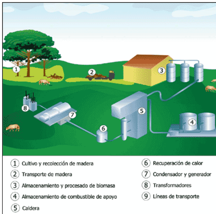
Figura. 2.13. Esquema de una planta de generación eléctrica usando biomasa.
