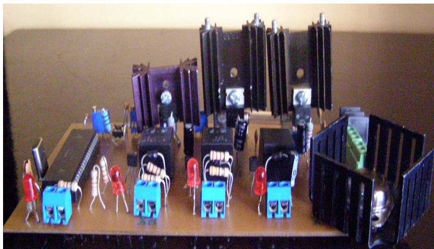
Figura. 5. 4 Vista frontal de la tarjeta del controlador del sistema de respaldo de energía.
