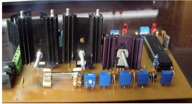
Figura. 5. 5 Vista posterior de la tarjeta del controlador del sistema de respaldo de energía.
