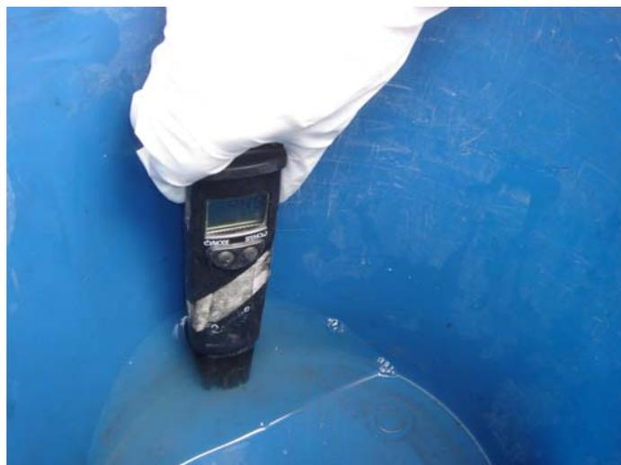
Medición de pH en una muestra de agua
