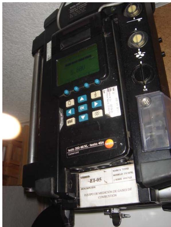
Analizador de gases TESTO
