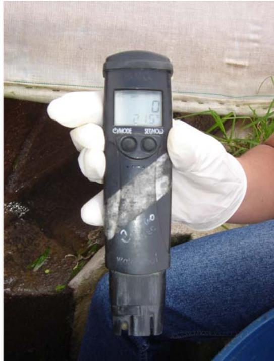
pHímetro utilizado para medir la acidez y temperatura del agua
