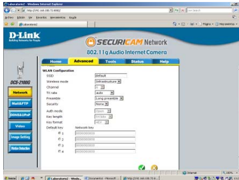
Figura. 7.62. Configuración de parámetros de red WLAN
