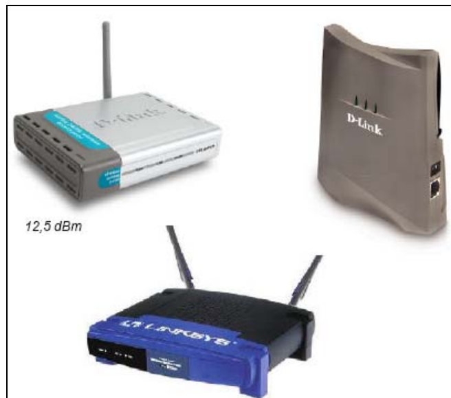
Figura. 3.9. Puntos de acceso, similares a HUB o concentradores
