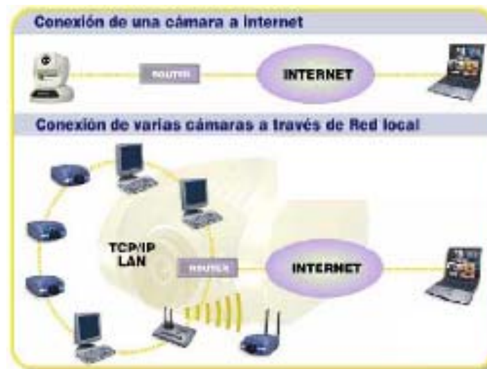
Figura 4.20 Tipos de configuración de cámaras IP
