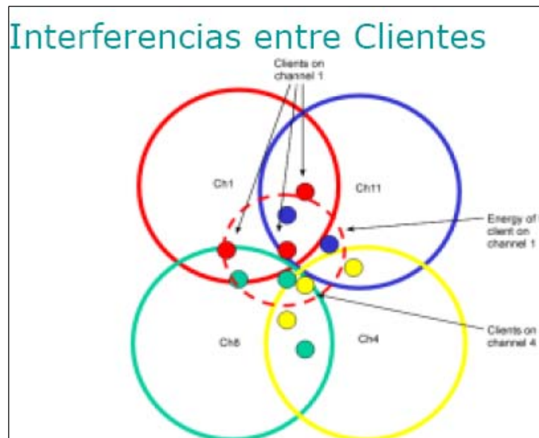
Figura. 5.2. Interferencia entre clientes acorde al canal que ocupan
