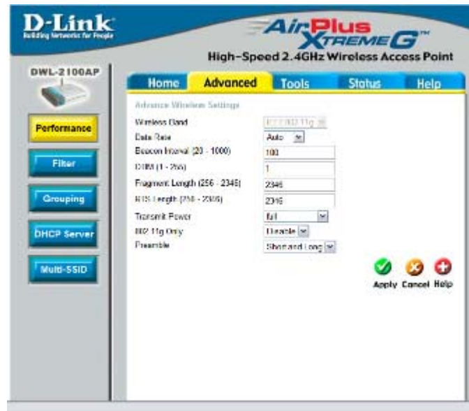
Figura. 7.20. Parámetros de configuración WLAN
