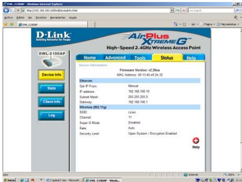
Figura. 7.13. Información LAN y WLAN del AP.
