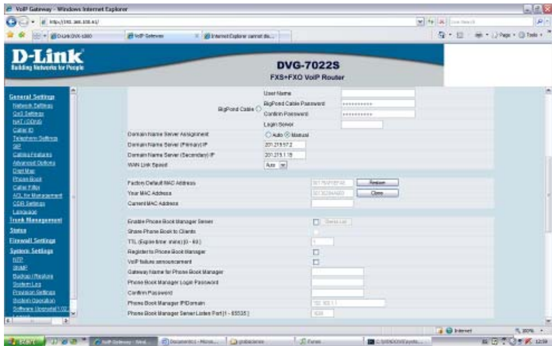
Figura. 7.48. Pantalla de configuración de red del DVG-702S
