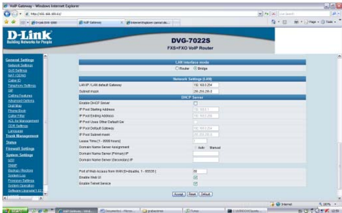
Figura. 7.49. Pantalla de configuración de red LAN del DVG-702S
