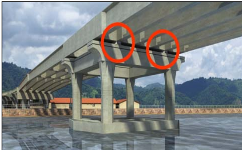
Figura 1. 20: Vista en 3D de los aisladores colocados sobre la viga cabezal (Romo, 2009)
