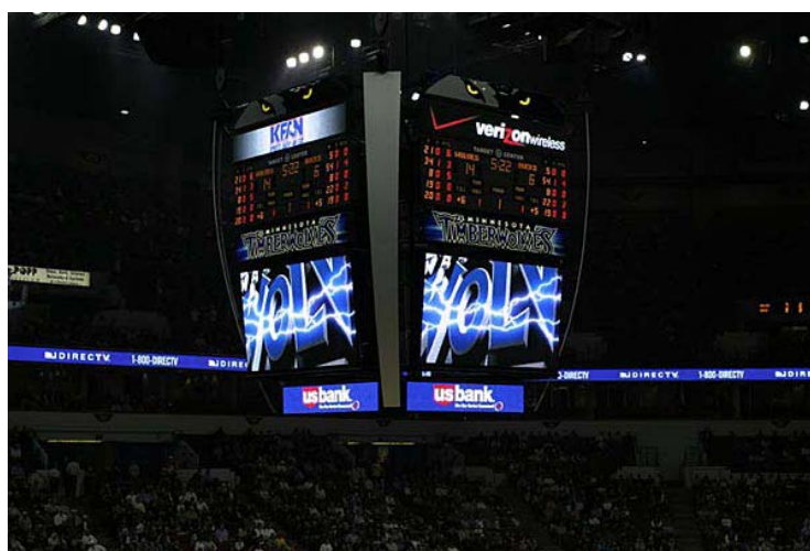
Figura 1.1. Minneapolis Target Center. El tablero central de este estadio además de mostrar el marcador y las estadísticas de un partido tiene una pantalla de 3 m de alto por 5 m de ancho con una resolución de 10 \text{ mm}^2 por punto para mostrar imágenes y video.
