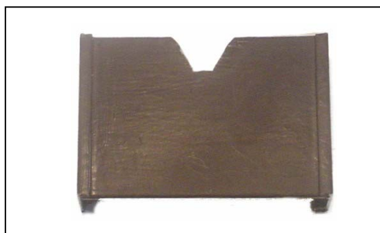
Figura 6.31. Cubierta del Circuito del Rotor
