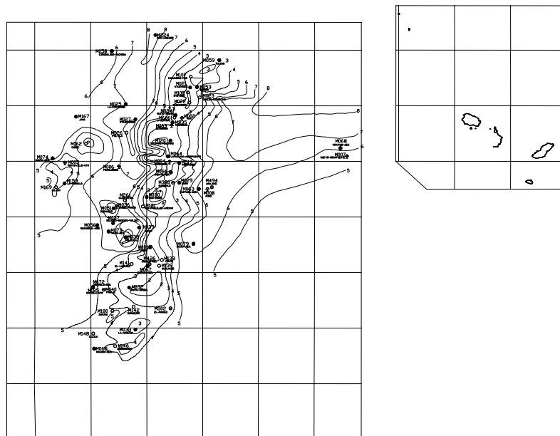
Gráfico 6.2. “Isolíneas de intensidades de precipitación para un período de retorno de 25 años en función de la máxima en 24 horas registro de información 1964 – 1998”. Fuente INAMHI.
