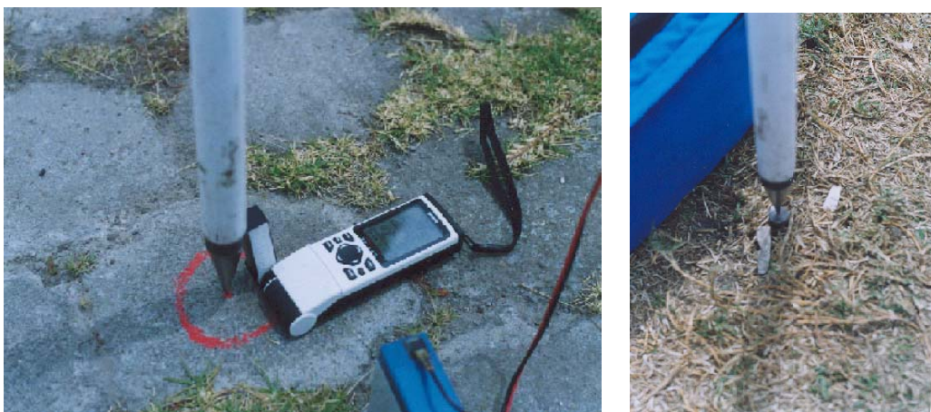
Foto 3.4. Varilla de acero en la estación 1 y círculo con pintura en la estación 21.
