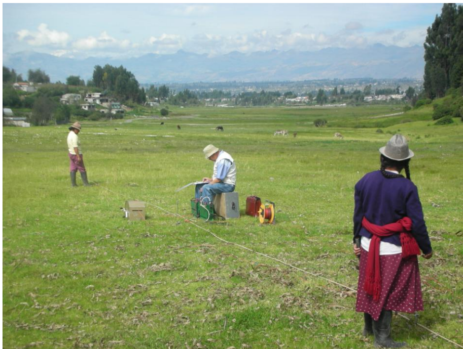
Fig. C.6 Tendida del equipo de sondeo eléctrico.
