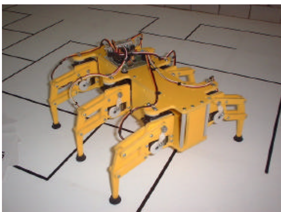
Figura.3.1.Robot Hexápodo con dos grados de Libertad
