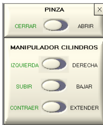
Figura. 5.28. Control del manipulador de cilindros.
