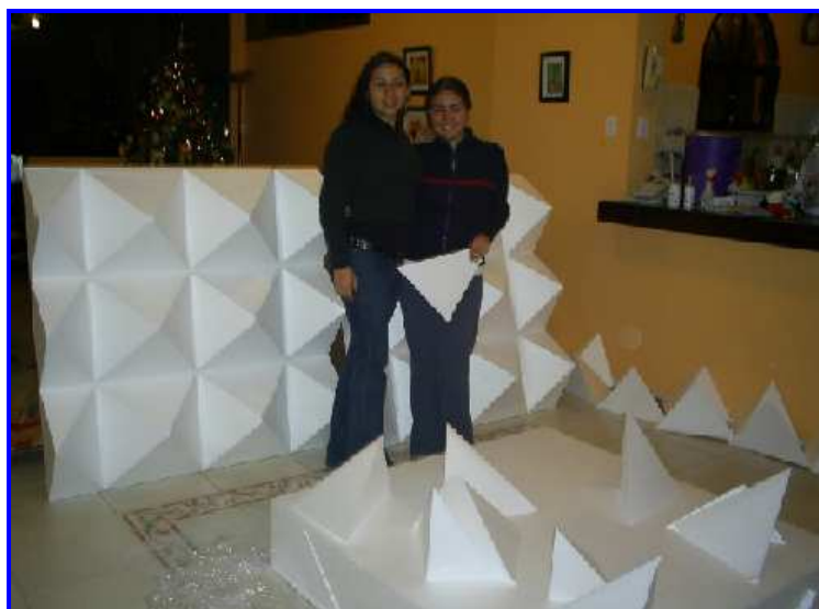
Figura. III.16. Planchas de poliestireno en forma piramidal
