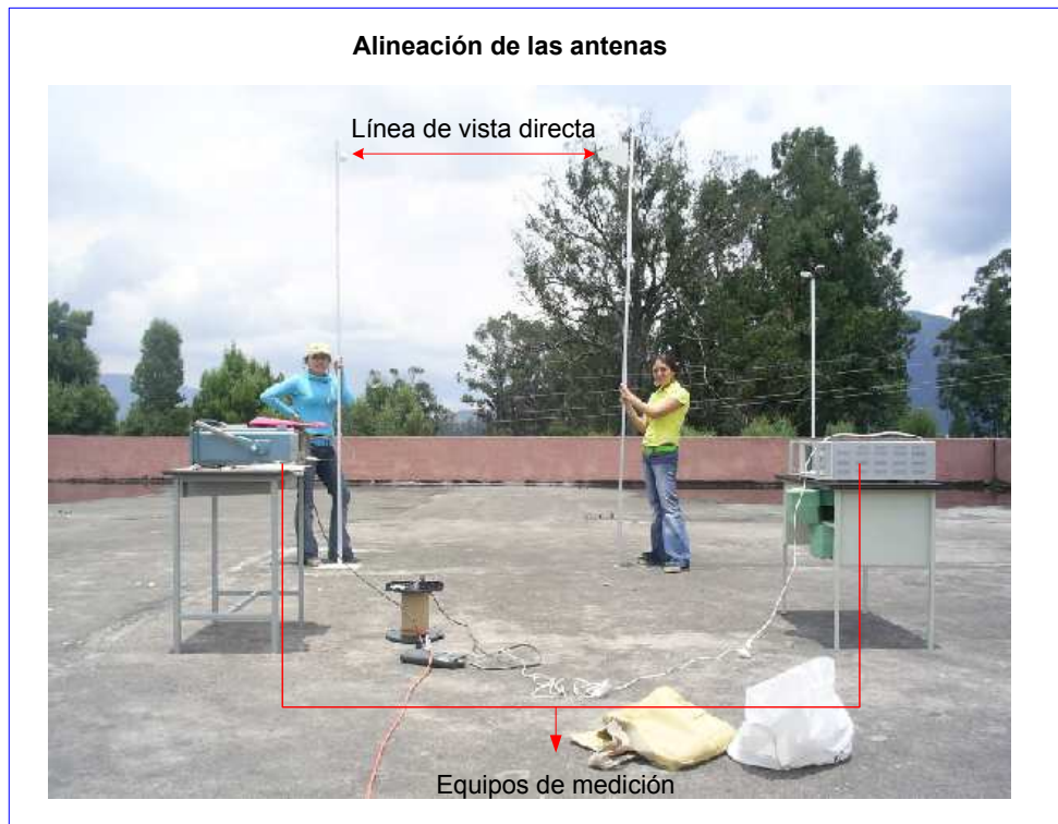
Figura. V.8. Alineación de las antenas a 3m de altura
