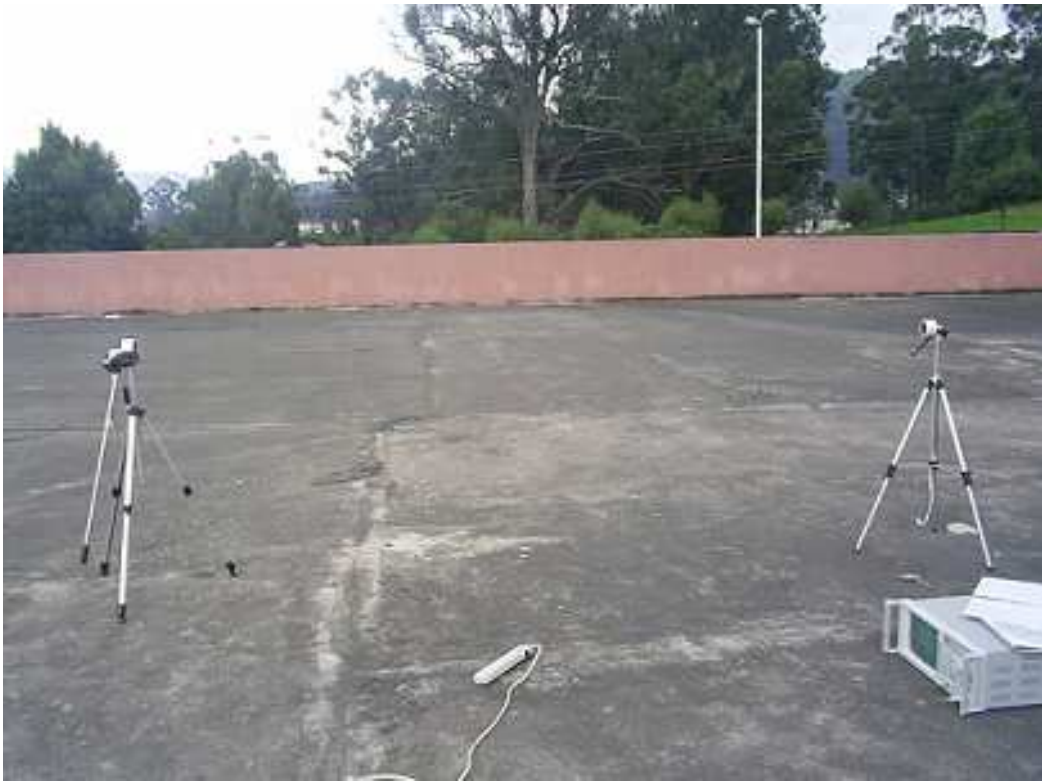
Figura. III.26. Posición de las antenas en el OATS
