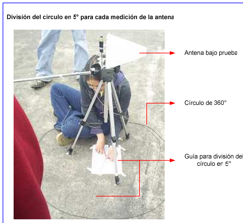
Figura. V.5. Guía de la antena para recolección de datos cada 5°
