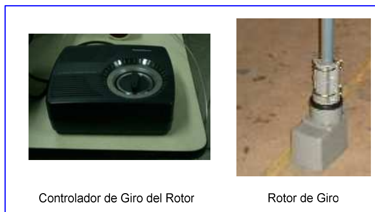
Figura. V.4. Sistema posicionador de la antena bajo prueba
