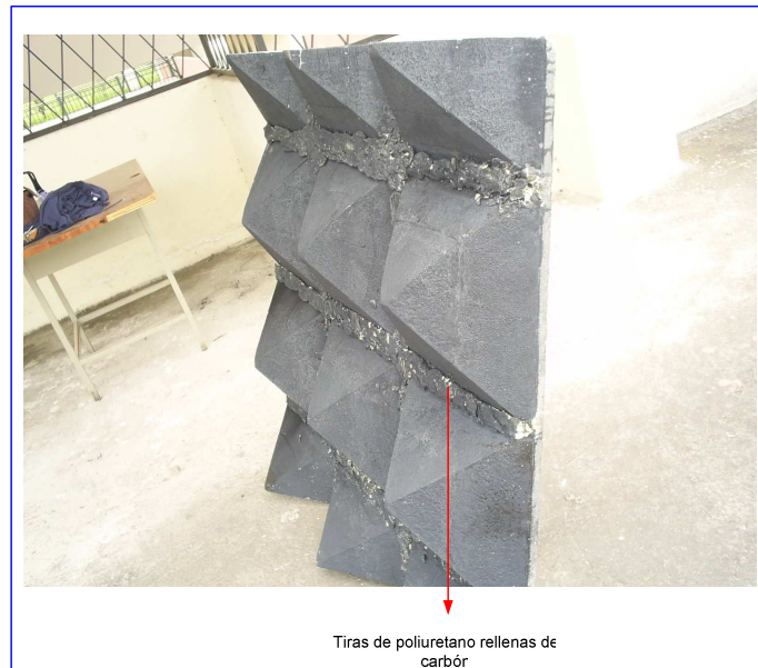
Figura. III.23. Plancha de poliestireno impregnada con carbón
