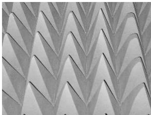
Figura. III.17. Planchas de poliestireno pintadas con la pintura Látex mezclada de carbón
