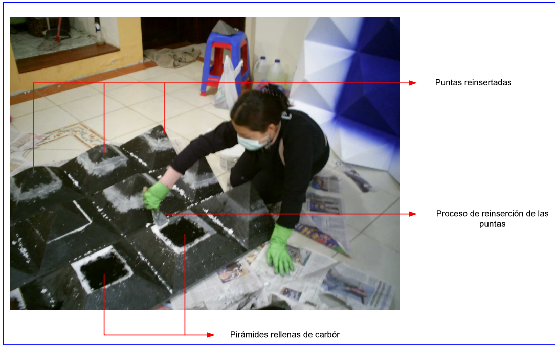
Figura. III.22. Cubrimiento de las planchas de Poliestireno impregnadas con carbón
