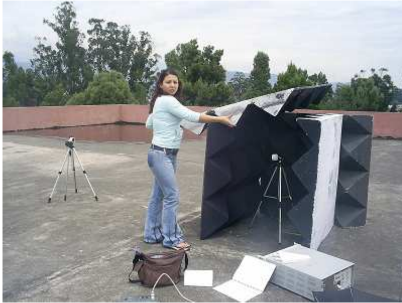
Figura. III.30. Antena bajo prueba cubierta de varias planchas de poliestireno impregnado de carbón
