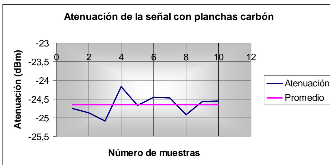
Figura. III.31. Atenuación de la señal con varias planchas de poliestireno rellenas de carbón
