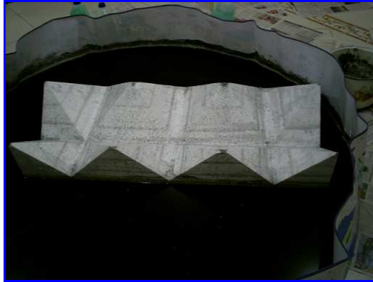
Figura. III.19. Plancha de poliestireno dentro de una piscina de Carbón Activado
