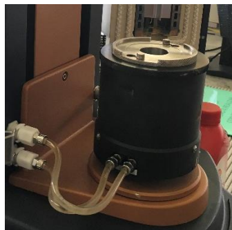
Compresímetro (Trisco Protune, apreciación 5bares)
