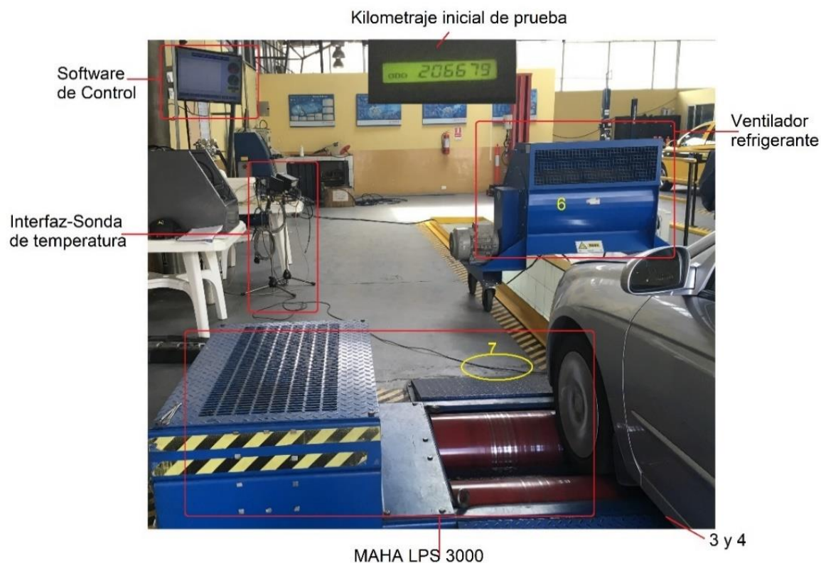
Figura 16. Procedimiento 1-7 prueba de torque y potencia
