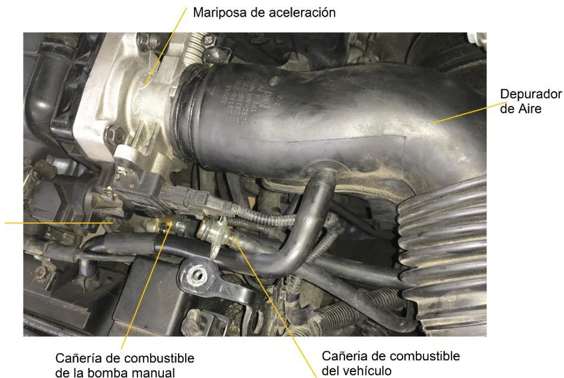
Figura 18. Cambio de la cañería de admisión de combustible a la bomba manual
