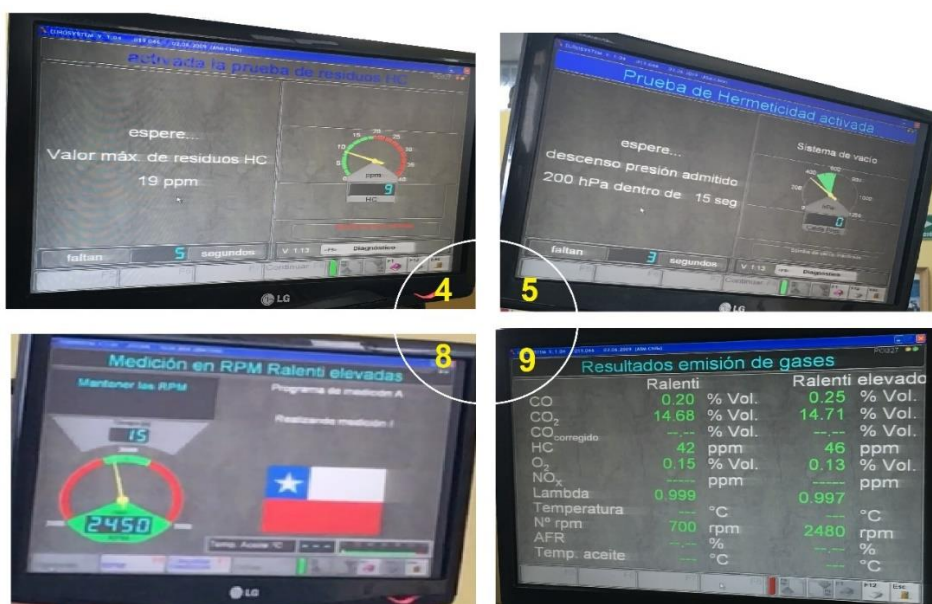
Figura 23. Pantallas mostradas en el software de control MAHA, pasos 4,5,8,9
