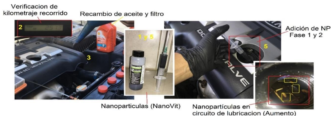
Figura 25. Procedimiento de adición de nanopartículas en el aceite lubricante
