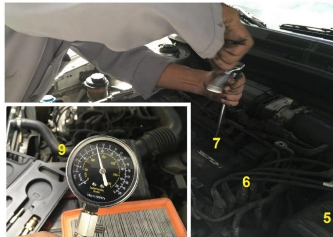
Figura 15. Esquema de proceso de la medición de compresión. Pasos 5, 6, 7, 9.
