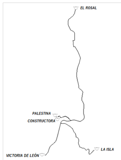
Figura 64. Conducciones hacia los tanques de distribución
