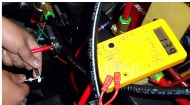
Figura 9. Medición de resistencia válvula moduladora
