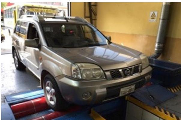
Figura 5. Prueba en el dinamómetro de rodillos
