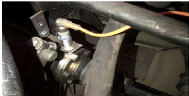
Figura 13. Ubicación del sensor de giro.
