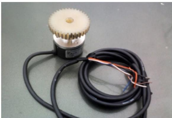
Figura 6. Sensor del Volante
