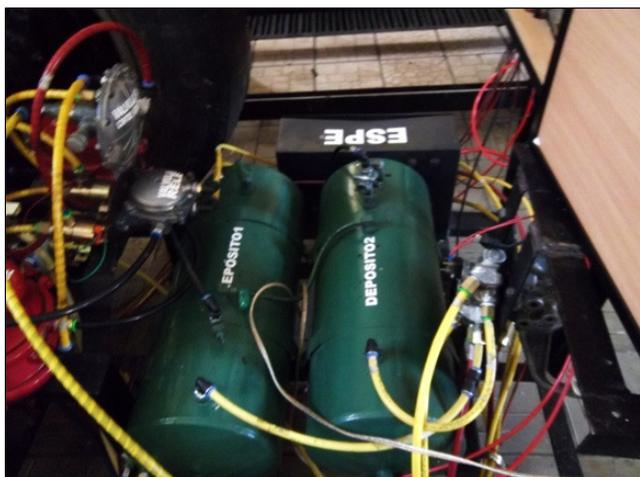
Figura 5. Banco de pruebas de frenos neumáticos
