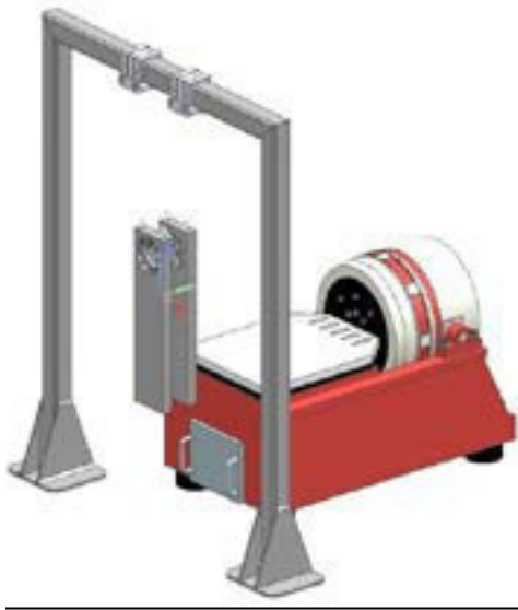
Figura 11. Montaje para marco y placas.
