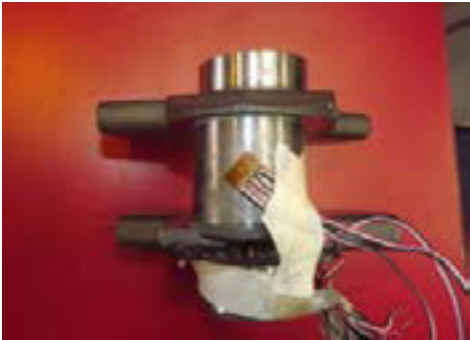
Figura 8. Cigüeñal instrumentado con roseta de deformación.
