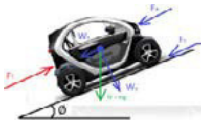
Figura 5. Acción de fuerzas longitudinales.
