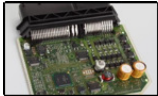
Figura 2. Componentes internos de la ECM
