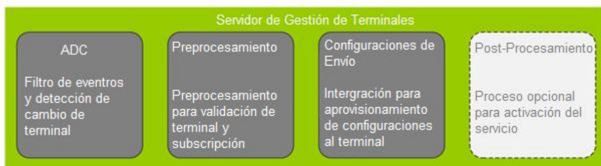
Figura 3.8. Arquitectura Rubros funcionales del Device Management Server. El componente rayado es opcional.
