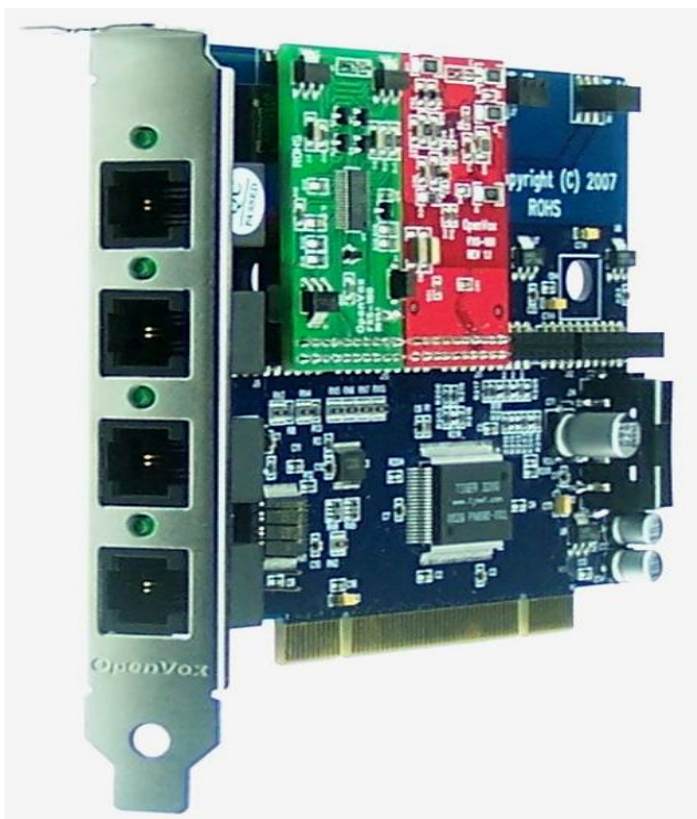
Fotografía. IV.3. Tarjeta PCI con un módulo FXS y un FXO
