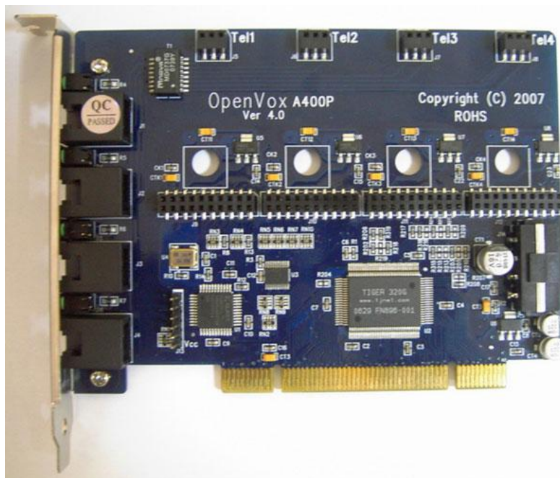
Fotografía. IV.1. Tarjeta PCI de 4 puertos para módulos FXS/FXO
