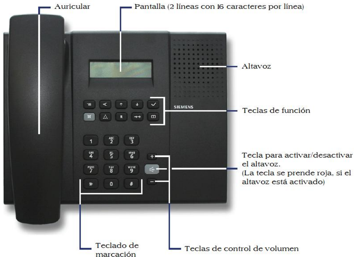
Figura. II.31. Partes del teléfono OPTIPOINT 150 S 13 Fuente: [OPT150]
