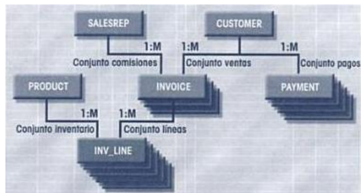
Figura. I.13. Estructura de Base de Datos de Red
