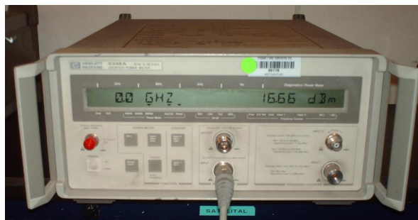
Figura. 4.49. Medición de Potencia con Power Meter
