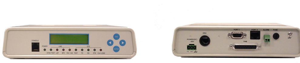
Figura. 2.75. Principales componentes IDU DART modelo FE1 CSU/DSU - V.35 (DB-25)
