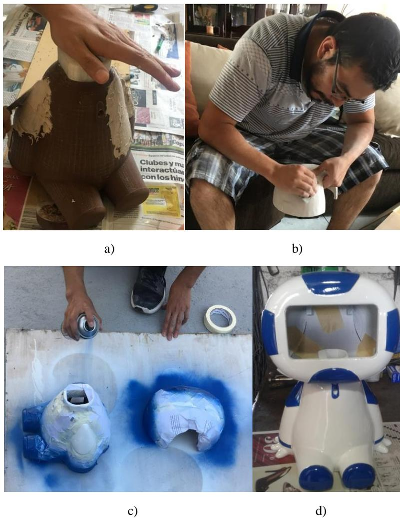
**Figura 52.** a) Colocación de macilla b) Pulido
