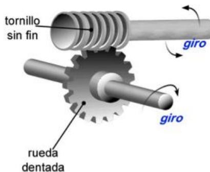
**Figura 27.** Mecanismo de tornillo sin fin
