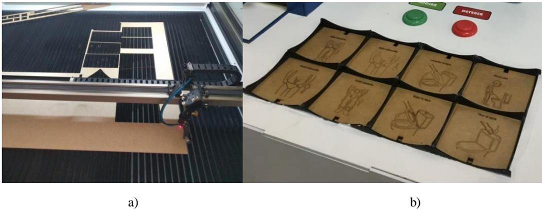
**Figura 53.** a) Corte láser en MDF b) Bandeja con grabado de rutina
