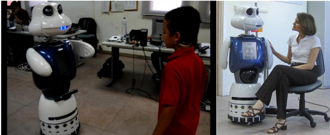
*Figura 15.* Interacciones del robot Maggie mediante salidas de voz y tacto
