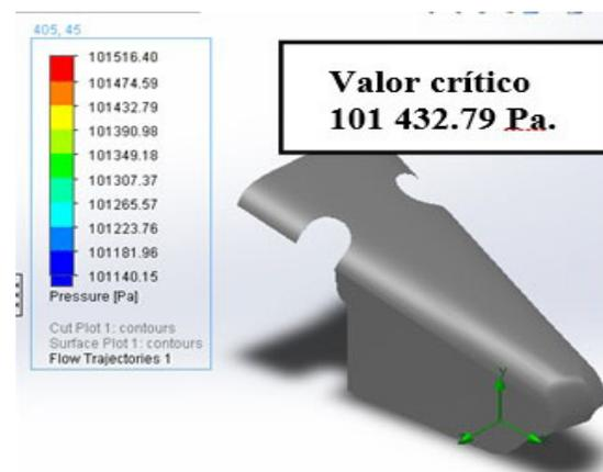
Figura 8. Resultados de la simulación fibra de vidrio.
