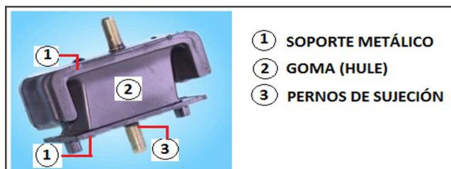
Figura 2. Elementos de la base motor
