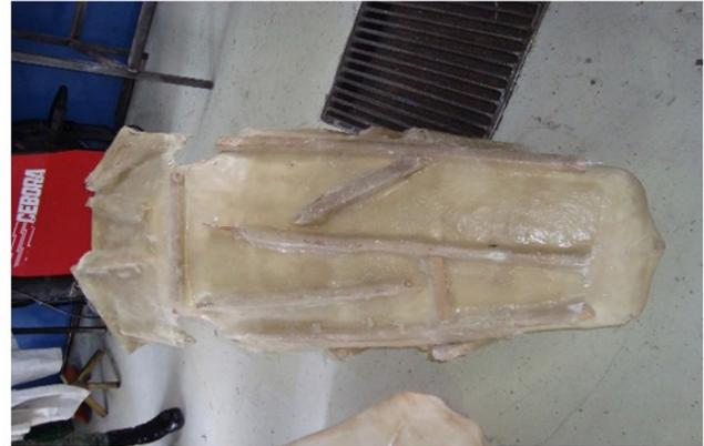
Figura 10. Molde de la carrocería.
