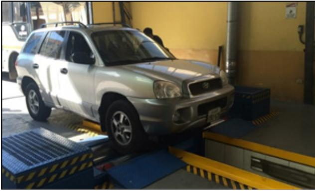
Figura 4 Evaluación de potencia en el dinamómetro de rodillos [5]
