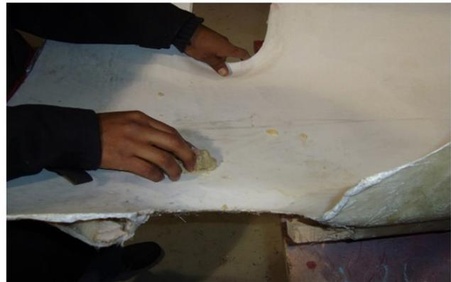
Figura 11. Colocación de la cera desmoldante.
