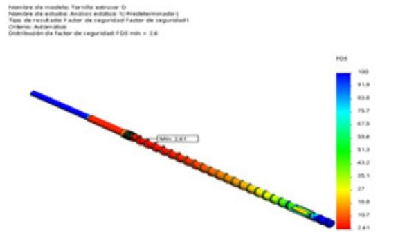
Figura 5. Factor de seguridad del tornillo extrusor
