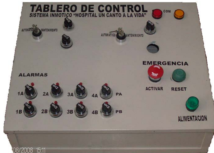
Figura 3.11 Tablero de control sistema inmótico
