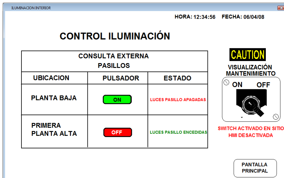
Figura 4.15 Pantalla de iluminación interna, estado de mantenimiento en ON
