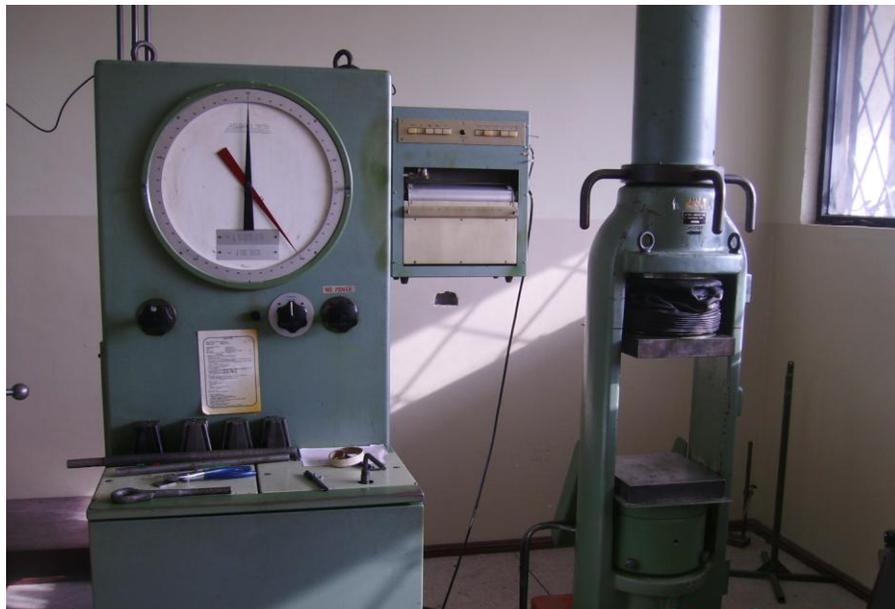
**Figura 3.12.** Máquina universal de ensayos con dispositivo para aplicar cargas axiales de compresión
