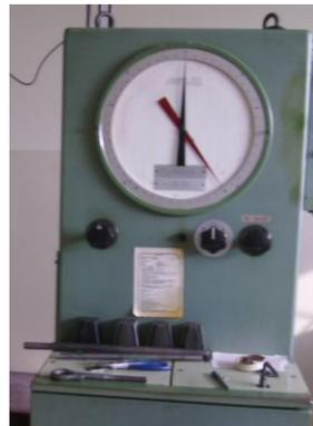
**Figura 3.1.** Máquina de ensayos universal con dispositivo para flexión
