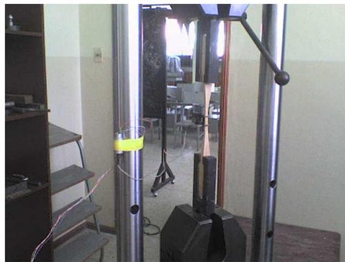
**Figura 3.7.** Probeta en proceso de carga
