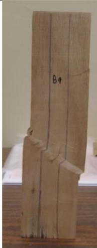
**Figura 3.14.** Probeta ensayada
