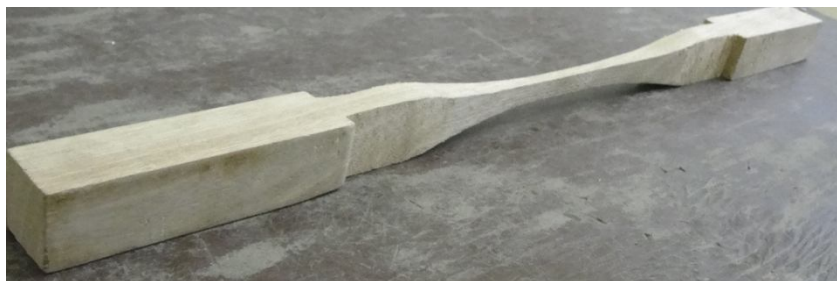
Figura 4.15 Probeta para tracción paralela al grano
