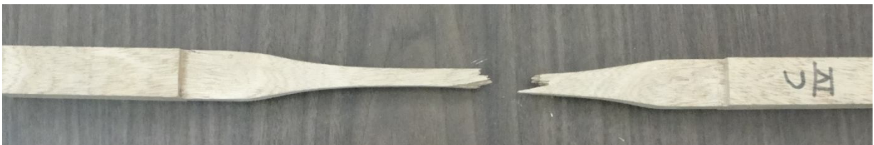
Figura 4.18 Tipo de falla a tracción paralela al grano
