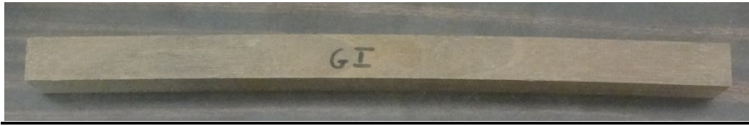
Figura 4.35 Probeta para ensayo de Flexión Estática
