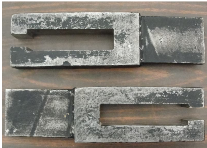
Figura 4.14 Mordazas para tracción paralela al grano
