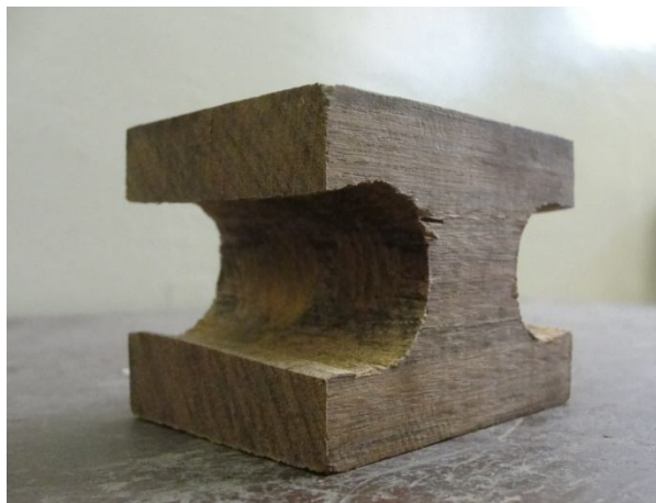
Figura 4.22 Probeta para tracción perpendicular al grano
