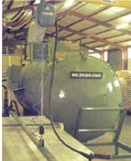
Figura 2.16 Cámara de vacío
