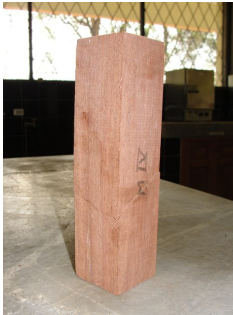
Figura 4.6 Falla por corte diagonal
