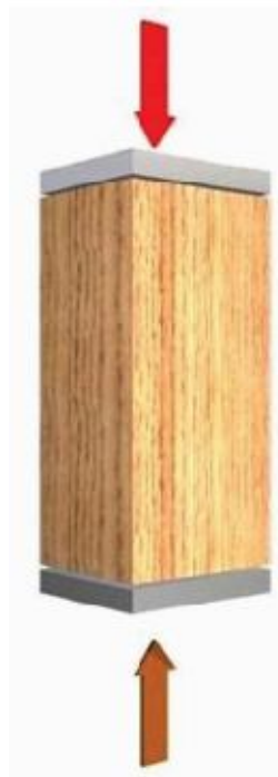
Figura 4.2 Esquema de ensayo de compresión paralela a las fibras
