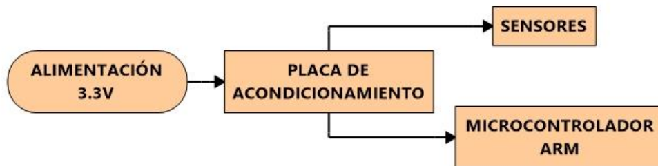
Figura 46. Diagrama de bloques de la adquisición de datos
