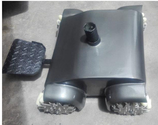
Figura 38. Construcción de la tapa de fibra de vidrio
