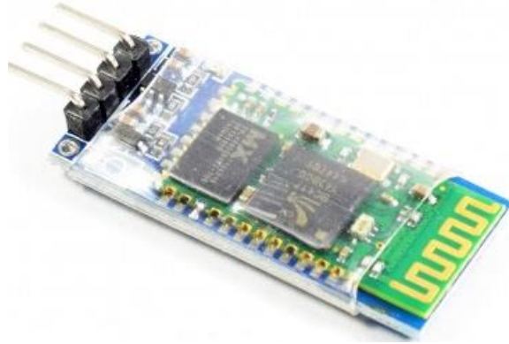
Figura 61. Módulo Bluetooth HC-06
