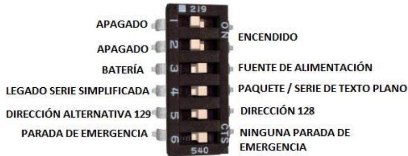
Figura 44. Configuración del interruptor DIP en modo serie Fuente: (Dimension Engineering, 2016)
