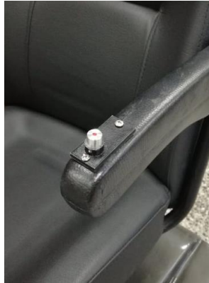
Figura 52. Paro de emergencia
