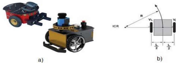
Figura 4. Configuración diferencial. a) Robot Pioneer 2DX y Tetra-DS IV, b) Control de dirección
